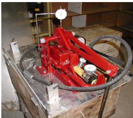
شکل ۴-۲۹- نمای کلی تجهیزات مورد نیاز برای آزمایش مقاومت برشی درزه [۷۲]
