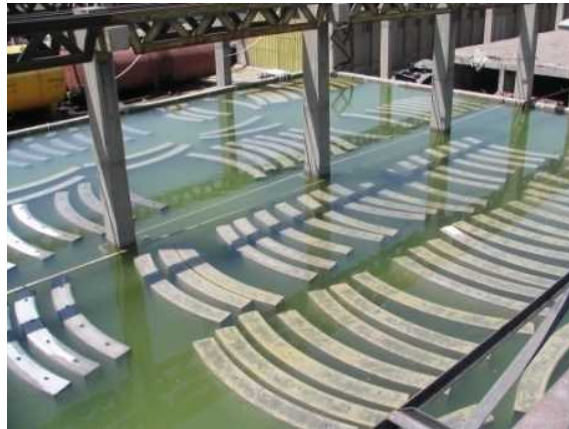
شکل ۱۲-۲۰- داخل کردن قطعات سگمنتی بصورت ایستاده (کتابی) در استخر آب به منظور عمل آوری با آب
