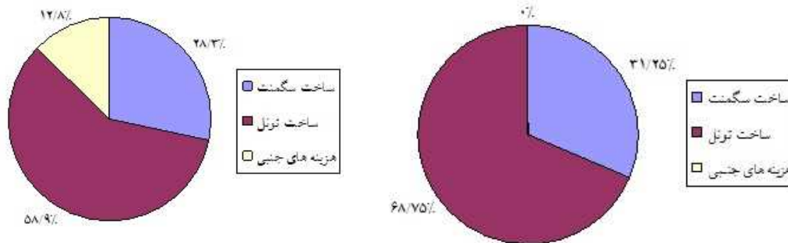
ج - هزینه ساخت سگمنت بر حسب درصدی از هزینه ساخت تونل در کشور ایران (تونل با قطر ۸ متر و طول یک کیلومتر) د - هزینه ساخت سگمنت بر حسب درصدی از هزینه ساخت تونل در کشور ایران (تونل با قطر ۴ متر و طول ۴ کیلومتر) شکل ۱۴-۲ - هزینه ساخت پوشش داخلی بتن پیش ساخته (سگمنت) به تفکیک اجزاء کار و بر حسب درصدی از هزینه ساخت تونل
