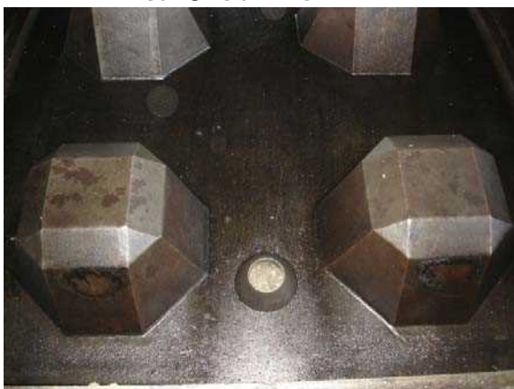
حفره‌های موجود در قالب برای تزریق یا بلند کردن سگمنت
