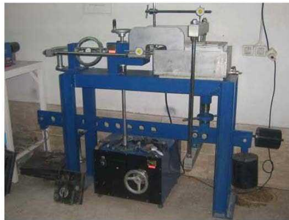
شکل ۴-۳۸- نمونه‌ای از دستگاه برش مستقیم در آزمایشگاه
