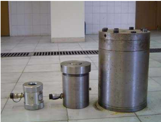
شکل ۴-۲۷- سلول هوک جهت انجام آزمایش مقاومت فشاری سه محوری
