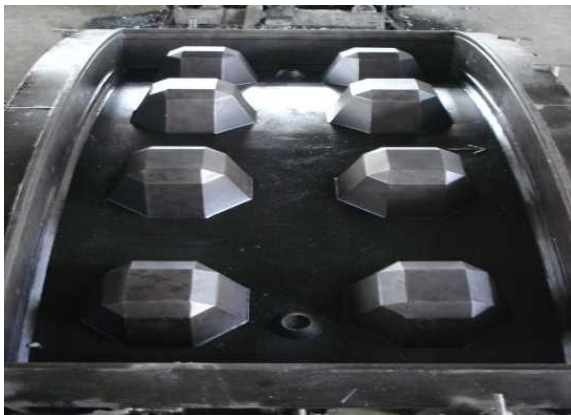
روغنکاری قالب برای بتن ریزی
