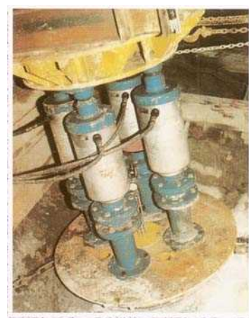
شکل ۴-۳۱- نحوه انجام آزمایش بارگذاری صفحه‌ای در سنگ
