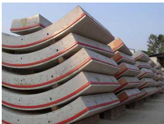
نصب نوارهای آبی‌بند بر روی قطعات سگمنت
