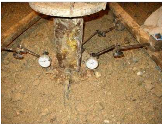
قرارگیری گیج‌ها در محل‌های مختلف جهت ثبت نتایج آزمایش بارگذاری صفحه‌ای
