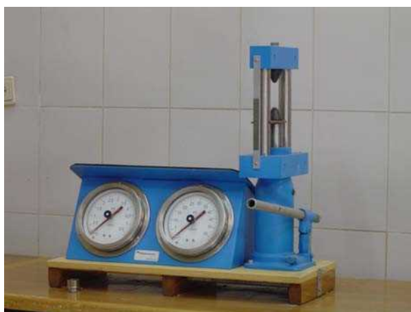
شکل ۴-۲۵- دستگاه آزمایش بار نقطه ای
