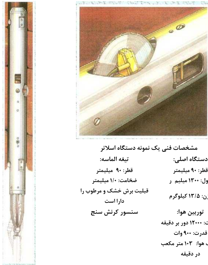
شکل ۴-۳۴- مشخصات فنی و شکل یک نمونه تجهیزات انجام آزمایش اسلاتر
