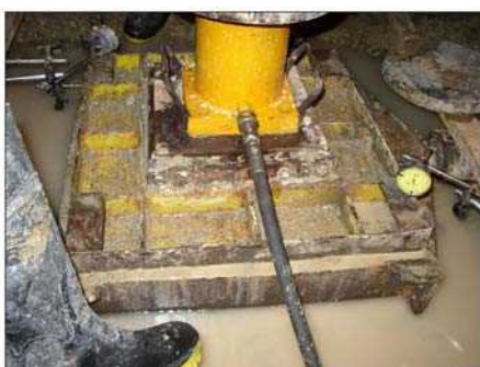
قرار گیری گیج‌ها در محل‌های مختلف جهت ثبت نتایج آزمایش برش مستقیم برجا شکل ۴-۴- نحوه انجام آزمایش برش مستقیم برجا در خاک
