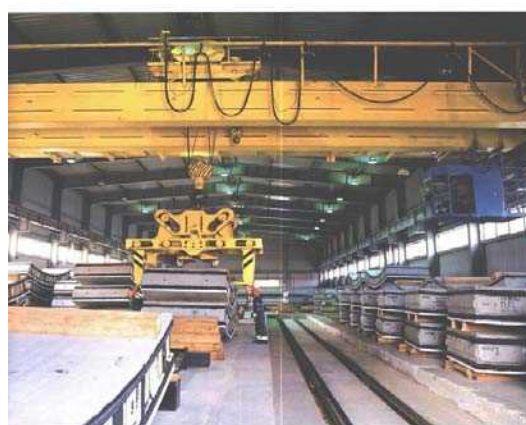
انتقال سگمنتها از خط تولید به استخر آب به منظور عمل آوری با استفاده از جرثقیل‌های سقفی
