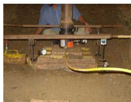
قرار گیری گیج‌ها در محل‌های مختلف جهت ثبت نتایج آزمایش برش مستقیم برجا شکل ۴-۴- نحوه انجام آزمایش برش مستقیم برجا در خاک
