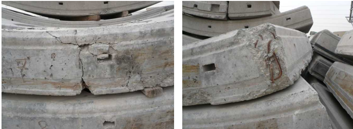
شکل ۱۲-۲۴- دو نمونه از آسیب دیدگی سگمنتها به علت شرایط نامناسب حمل و دپوی قطعات سگمنتی
