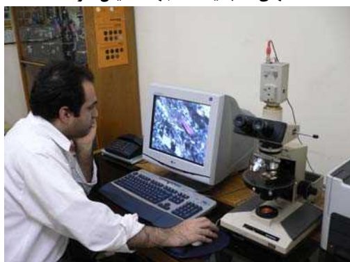
میکروسکوپ پلاریزان مجهز به دوربین دیجیتالی و سیستم کامپیوتری
