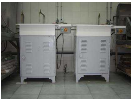
دستگاههای ساب ایستاده جهت سایش نمونه‌ها
