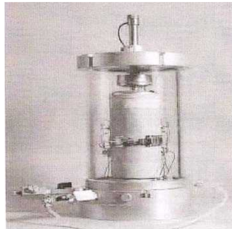
شکل ۴-۳۹- تصویری شماتیک از دستگاه آزمایش سه محوری
