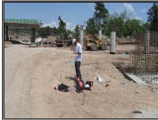
شکل ۴-۴۵- نحوه اجرای روش ژئوالکتریک
