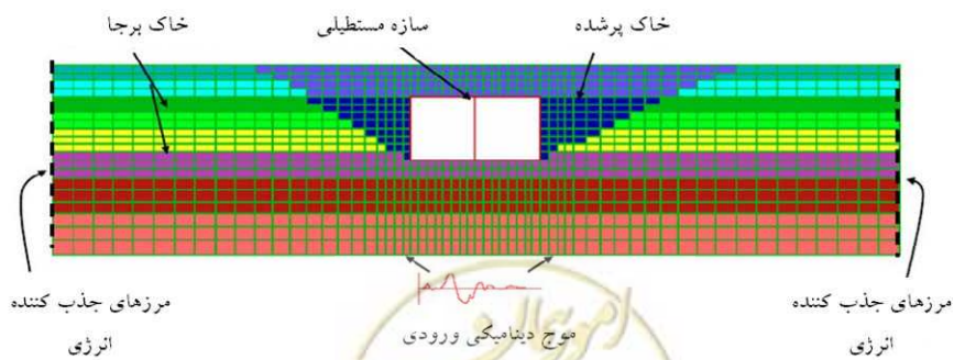
شکل ۹-۲۰- مدل اجزاء محدود تونل کند و پوش
