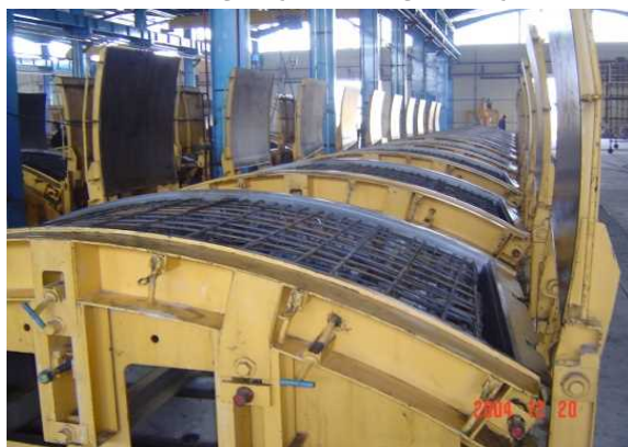
قالب و قفسه آرماتوربندی آماده شده برای بتن ریزی
