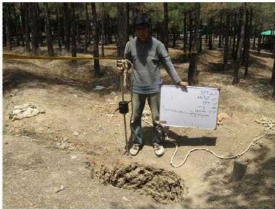
شکل ۴-۴۱- آزمایش ضربه و نفوذ استاندارد S.P.T در داخل چاه اکتشافی
