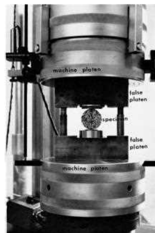
شکل ۴-۲۸- آزمایش برزلی جهت تعیین مقاومت کششی [۷۰]
