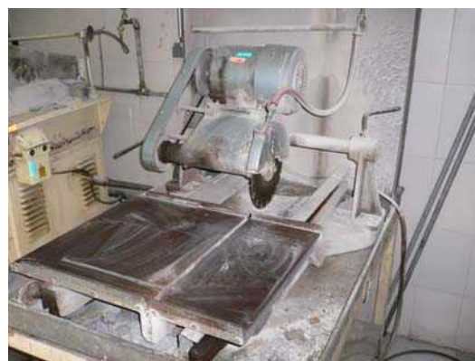
دستگاه برش بزرگ دارای ضخامت حدود ۳ میلیمتر جهت برش نمونه‌ها
