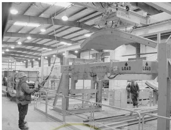
شکل ۱۲-۱۹- باز کردن قالبها و جدا کردن سگمنتها با استفاده از انواع مختلف جرثقیل
