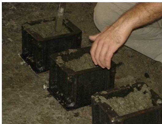
تهیه نمونه مکعبی برای انجام آزمایشات مقاومتی بر روی بتن
