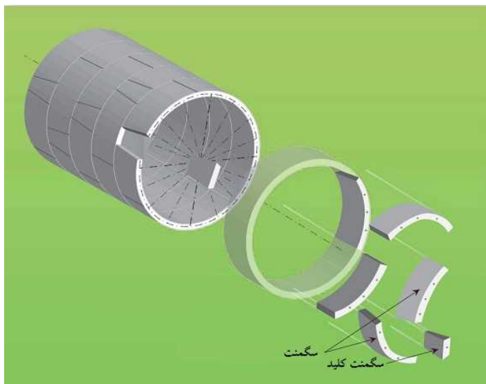
شکل ۱۲-۲۸- نمایی از نحوه قرارگیری سگمنتها در طول تونل [۲۳۳]
