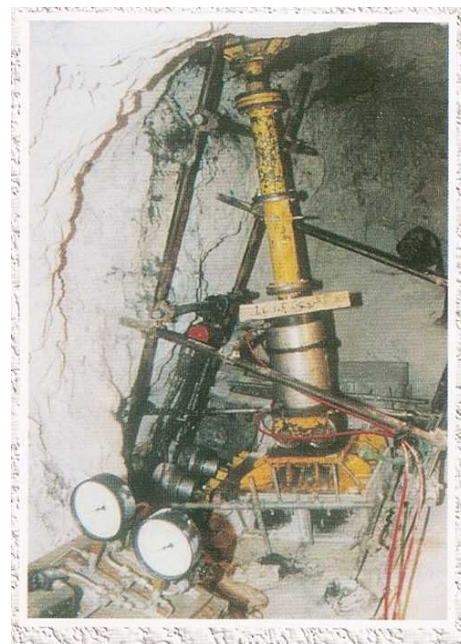
شکل ۴-۳۲- نحوه انجام آزمایش برش مستقیم برجا در سنگ [۷۵]
