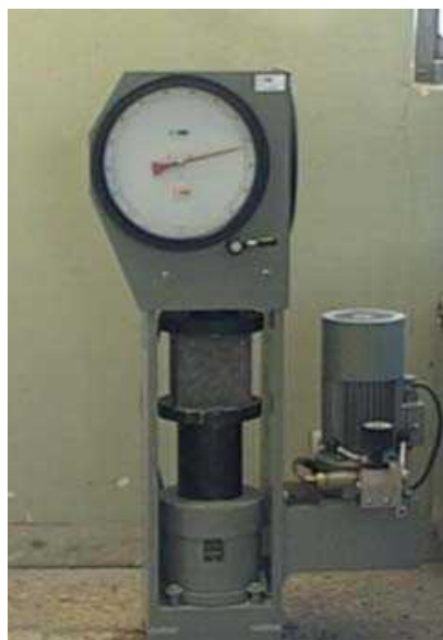
انجام آزمایش مقاومت فشاری تک محوره بر روی نمونه‌های مکعبی شکل ۱۱-۳- تهیه نمونه‌های مکعبی از بتن و انجام آزمایشات مقاومتی
