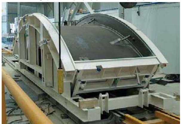
نمایی از قالب آماده شده برای جایگذاری قفسه آرمانتور و بتن ریزی [۲۳۰] شکل ۱۲-۱۲- مراحل ساخت و آماده کردن قالب برای تولید قطعات سگمندی
