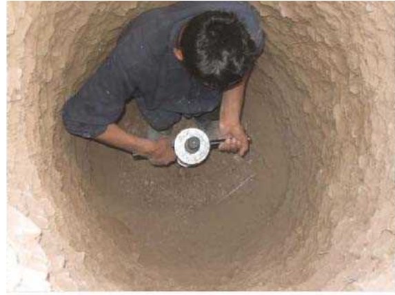
شکل ۴-۴۱- آزمایش ضربه و نفوذ استاندارد S.P.T در داخل چاه اکتشافی
