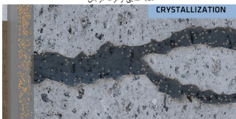
ب) اجرای غشاء کریستال ساز روی دیواره (سمت چپ بر روی سطح)
