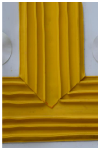
شکل ۳-۴۹- اتصال سه راهی و تراستاپ خارجی - اهمیت آب‌بندی یکسان برای هر دو درز
