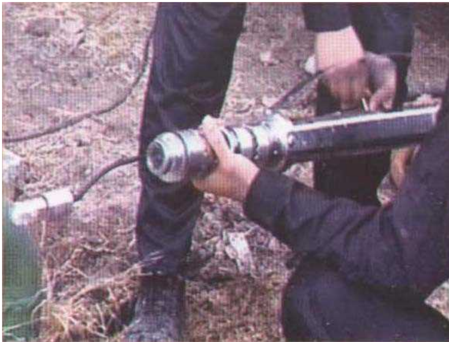
شکل ۴-۸- سنسور دستگاه چاه‌نگار
