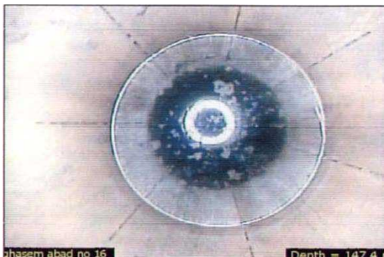
شکل ۴-۱۷- شروع لوله جدار مشبک از عمق ۱۴۷/۵۰ متر
