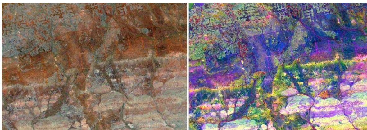
شکل ۴- تصویر رنگی (RGB=532) و بارز شده داده ماهواره WorldView-2 در محدوده یک سازند آهن دار
