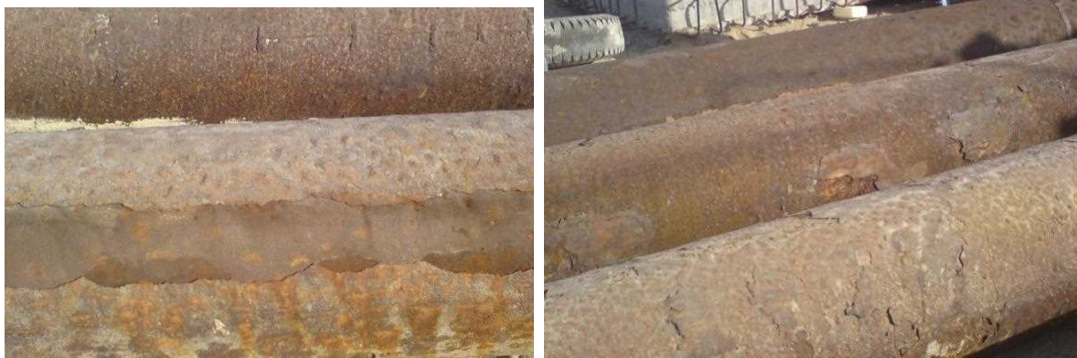
شکل الف-۱۳- خوردگی شمع فولادی در مجاورت دریا در فاصله زمانی بین انبار کردن تا اجرا به علت عدم حفاظت در برابر خوردگی
