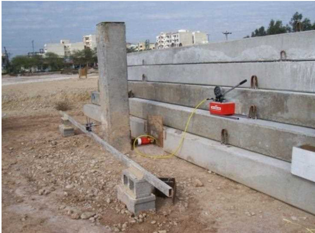
شکل الف-۲۲- تست بارگذاری استاتیکی جانبی
