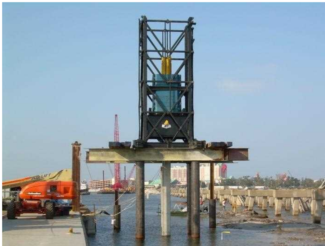
شکل الف-۲۰- تست بارگذاری سریع (Rapid Load Test)
