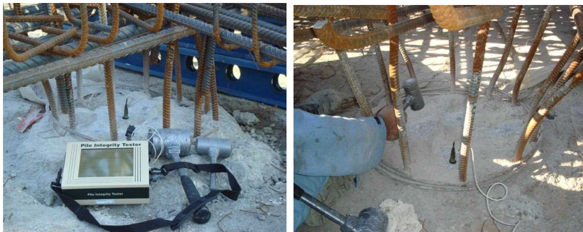
شکل الف-۱۸- تجهیزات تست کنترل یکپارچگی شمع PIT
