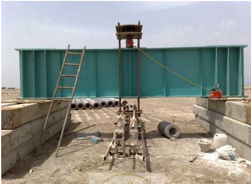
شکل الف-۲۳- تست بارگذاری استاتیکی کششی
