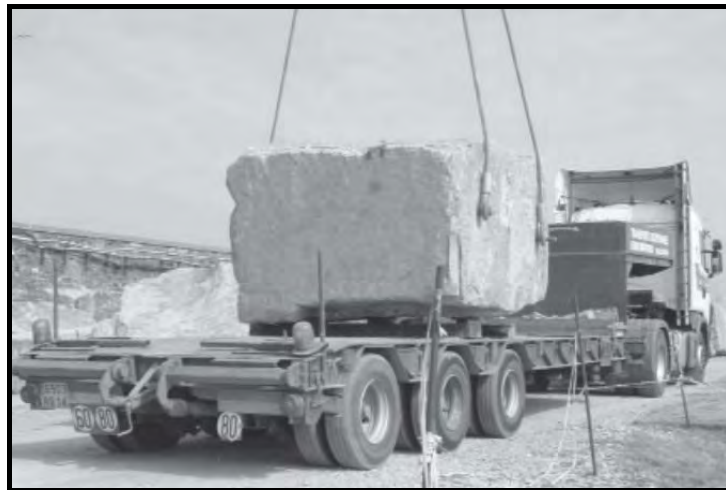
شکل ۵-۵- تریلی کفی که برای حمل قطعات بزرگ سنگ استفاده می‌شود
