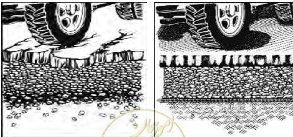
شکل ۳-۲۵- نقش ژئوسنتتیک در بهسازی بستر راه؛ الف- دارای ژئوتکستایل جداساز، ب- فاقد ژئوتکستایل جداساز
