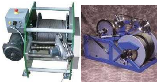
شکل ۲-۷- نمونه‌ای از وینچ‌های دستگاه چاه‌پیمایی
