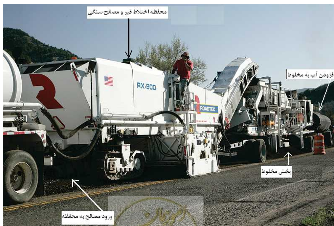
شکل ۵-۴- نمونه‌ای از دستگاه مخلوط‌کننده چرخشی عمل جمع‌آوری مصالح سنگی ریسسه‌شده در طول مسیر، اضافه‌کردن فیبر در داخل محفظه و پخش آسفالت سرد را انجام می‌دهند.
