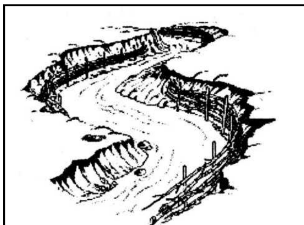
شکل ۵- ۲۱- کشت طولی قلمه‌ها برای حفاظت کناره‌ها
