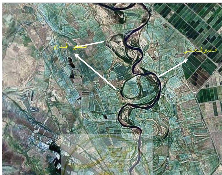
شکل ۴-۲۰- اثرهای برجای مانده از تغییرات مسیر رودخانه در عکس هوایی
