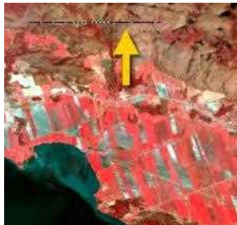
شکل ۳-۷ - الف - خط‌خطی شدن . ب - خط جامانده (CCRS, 1998)
