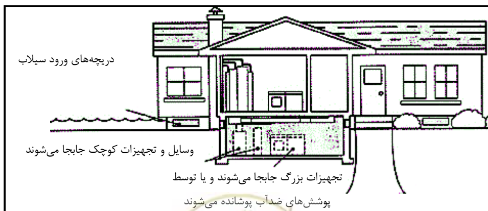
شکل ۵-۱۰- دریچه‌های ورود سیل و اقدامات مورد نیاز در پادسیل‌سازی مرطوب [۶۳]
