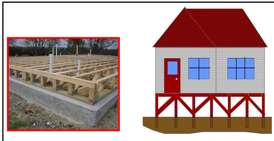
شکل ۳-۲- استفاده از شمع برای افزایش ارتفاع
