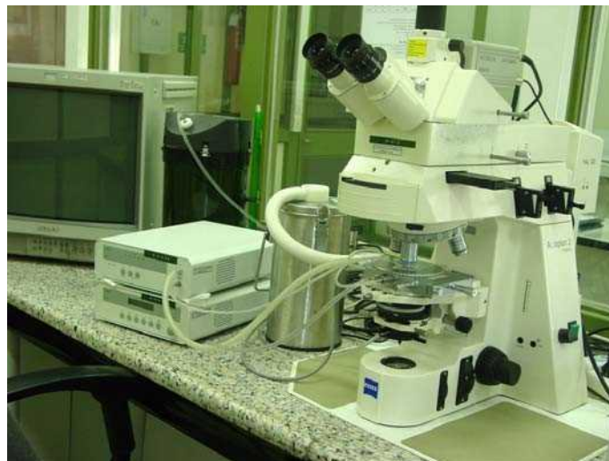
شکل ۵-۱- میکروسکوپ مجهز به صفحه گرم‌کننده و سردکننده
