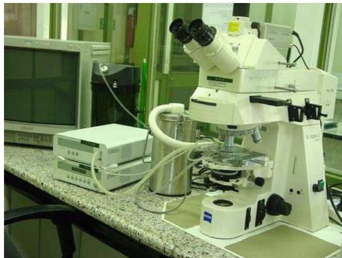
شکل ۵-۱- میکروسکوپ مجهز به صفحه گرم‌کننده و سردکننده
