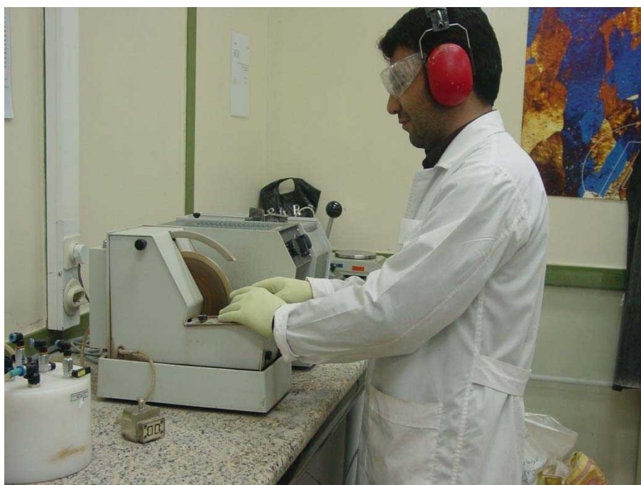
شکل ۲-۲- دستگاه برش سنگ که علاوه بر برش می‌توان با آن نمونه را تا ضخامت ۵۰ میکرون نازک کرد.
