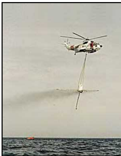
شکل ۲-۹- هلی‌کوپتر مجهز شده به سطل پاشش مجزا (REMPEC, 2011)
