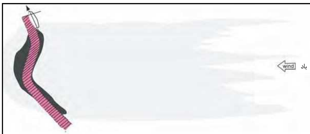
شکل ۲-۲۶- شناور در حال اسپری کردن دیسپرسنت با زاویه بر روی لکه نفتی (REMPEC, 2011)
