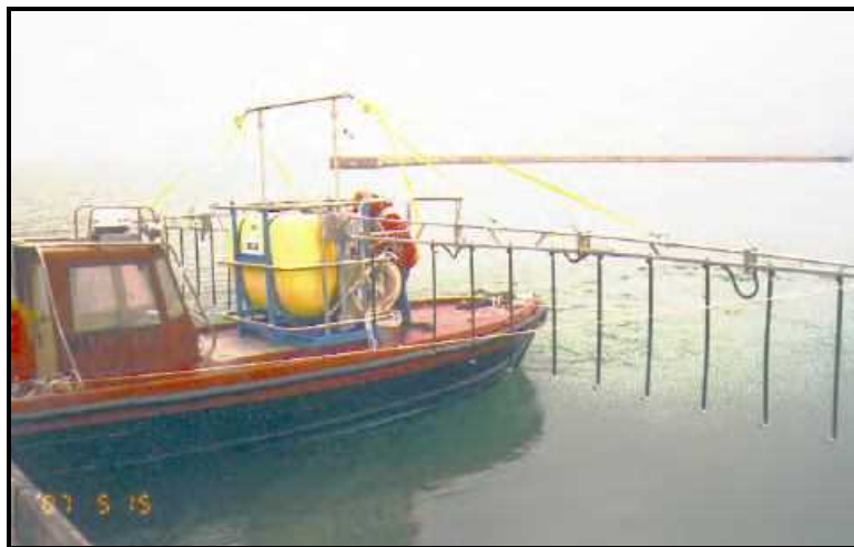
شکل ۲-۳- سیستم اسپری دیسپرسنت معمولی در قایق‌ها (REMPEC, 2011)
