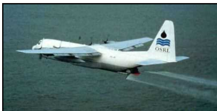
شکل ۲-۷- سیستم‌های پاششی هوابرد (با ۲۰ تن ظرفیت) (REMPEC, 2011)
