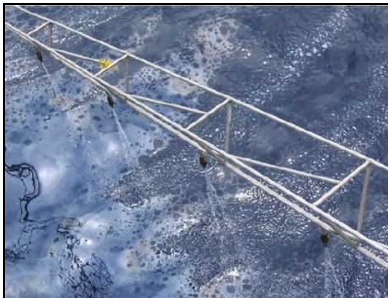
شکل ۱-۶- پخش دیسپرسنت‌ها توسط بازوهای متصل به قایق (ITOPF, 2009)
