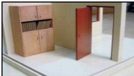
شکل ۳-۴- قفسه مهار نشده قبل از زلزله
