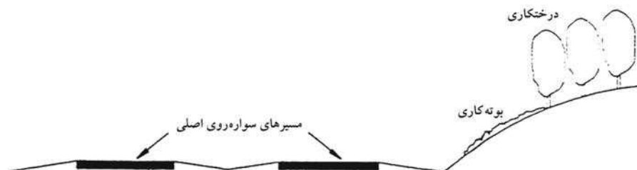
شکل ۳-۴۶- درخت کاری و بوته کاری مناسب در شیروانی خاکبرداری
