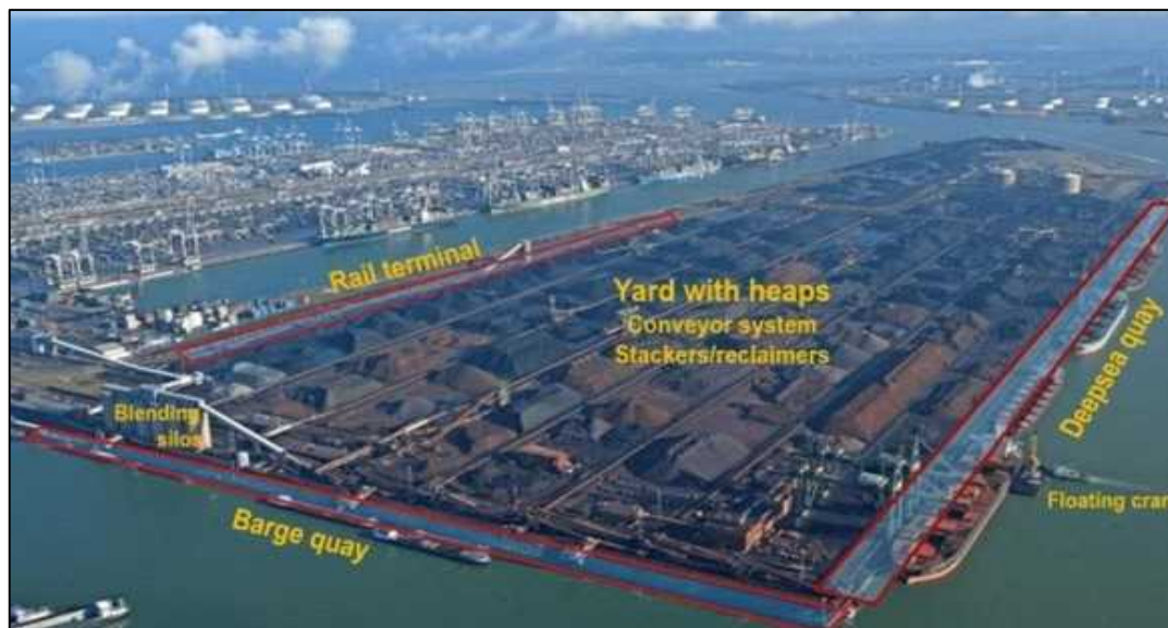
شکل ۱۳: نمونه محوطه بارگیری مواد معدنی ایزوله شده با سیستم زهکشی جداگانه
