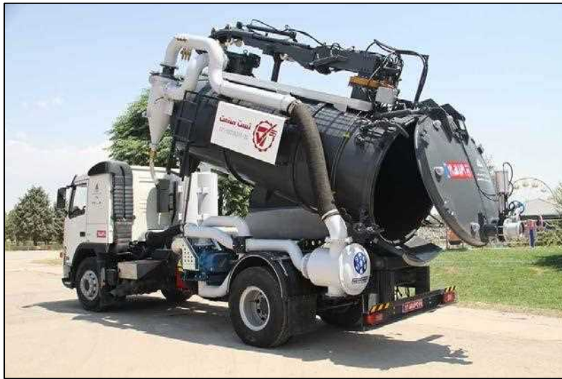
شکل ۶۰: نمونه از ماشین‌های شستشوی مجاری زهکشی
