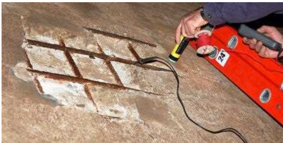
شکل ۲۰-۴ بازرسی به روش نیم سلول
