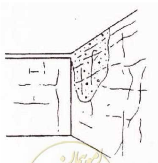
شکل ۴۹ → تصویر خوردگی شدید ناشی از حملات شیمیایی
