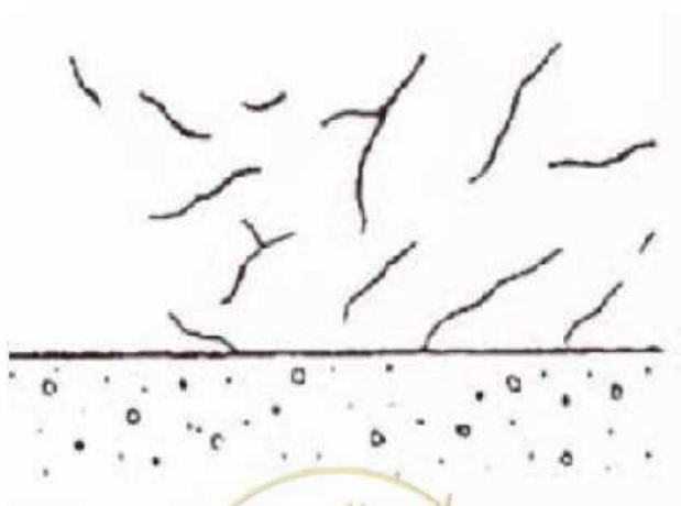
شکل ۵۵ → ترک ناشی از ترکیب نامناسب سیمان
