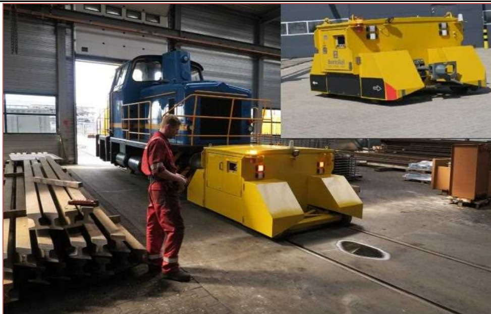
شکل ۴-۱ کشنده شارژی مجهز به باتری بدون راهبر با کنترل از راه دور
