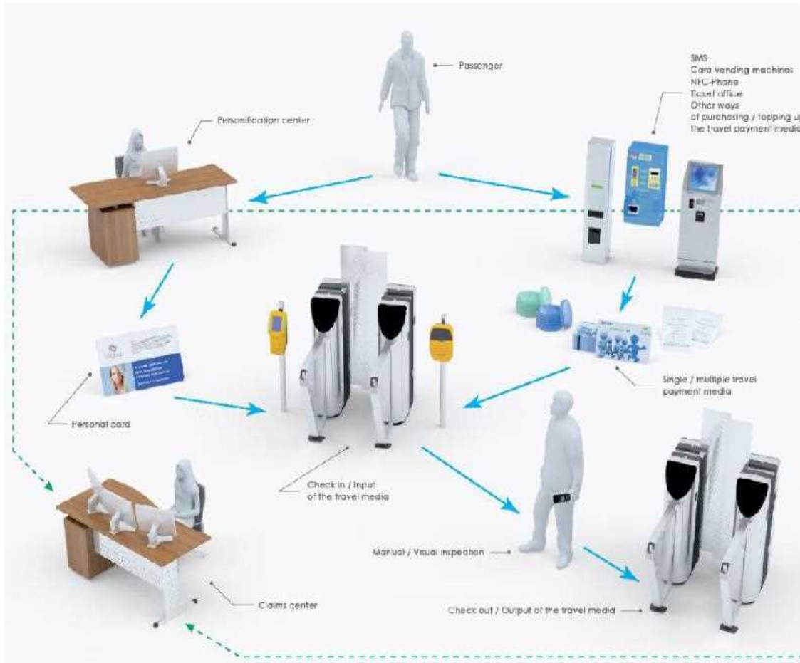
شکل ۱۰-۱ نمونه تجهیزات سامانه AFC
