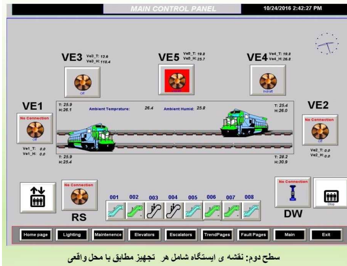
شکل ۱۲-۲ نمونه ای از سطح دوم واسط کاربر-ماشین
