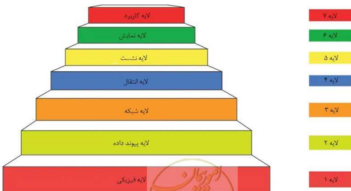
شکل ۳-۹- هفت لایه مدل اواس آی
