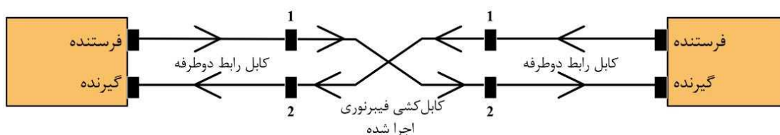
شکل ۲-۱۶- شماتیک سخت افزار اتصال
