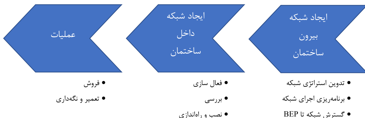
شکل ۲-۲۰- کلیات فازهای عملیاتی اجرای FTTH
