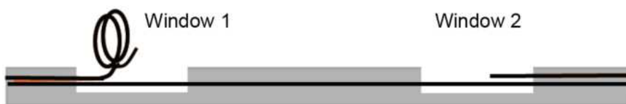
شکل ۱-۷۶- بیان مفهوم انشعاب‌گیری از میانه مسیر یا کمرگیری ۱
