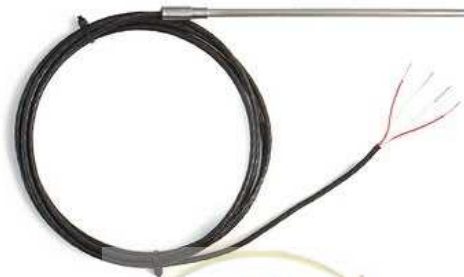
شکل ۳-۱۲- سنسور غیرفعال چهار سیم
