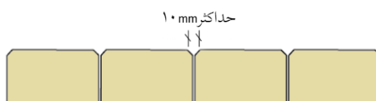
شکل ۲-۱۱: اتصالات بین سطوح با لبه پخ (مقطع)
