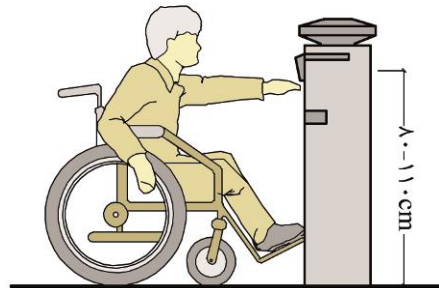
شکل ۲-۱۵۸: ارتفاع شکاف صندوق پست دسترس پذیر
