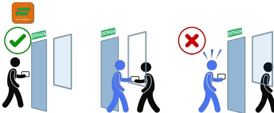
شکل ۱۰-۶- ایجاد وضعیتی که ورود دو یا چند نفر با یک کارت امکان‌پذیر نباشد
