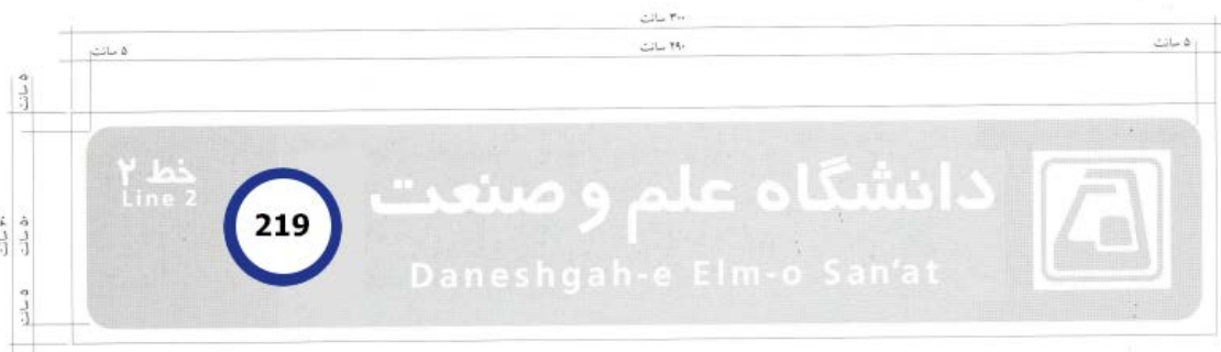
شکل ۴-۴ نحوه طراحی تابلو ورودی ایستگاه
