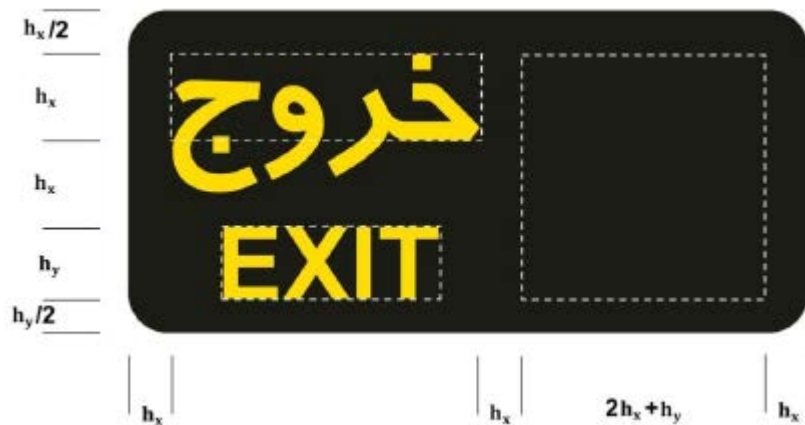
شکل ۳-۳ نحوه قرارگیری و اندازه‌های پیکان داخل تابلو
