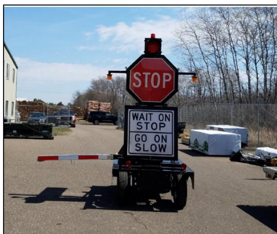
شکل پ ۲-۱۱ پرچمدار خودکار به همراه تابلوهای ثابت و یا چراغ‌های هشداردهنده
