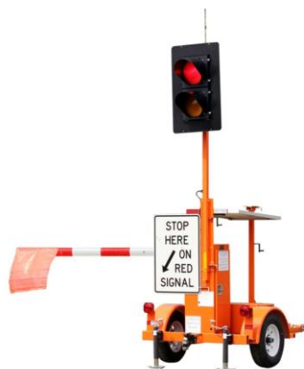
شکل پ ۲-۱۱ پرچمدار خودکار به همراه تابلوهای ثابت و یا چراغ‌های هشداردهنده
