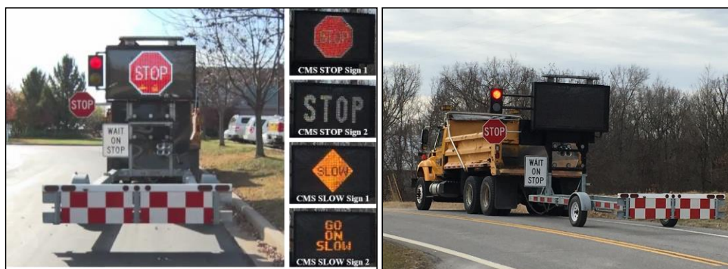
شکل پ ۲-۱۲ کامیون با پرچمدار خودکار و تابلوی هوشمند
