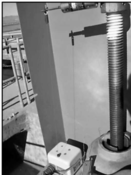
شکل ۳-۳۲- پتانسیومتر خطی و کابلی
