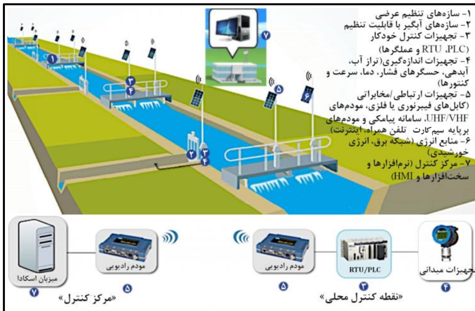
شکل ۱-۱-۱- نمایشی از اجزای سامانه کنترلی خودکار در یک شبکه آبیاری
