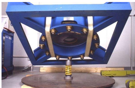
شکل ۷-۳: سطح بالایی و نمای زیرین جداساز Quantec
