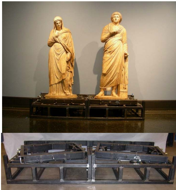
شکل ۳-۶: مجسمه‌های نصب شده (بدون پوشش پایه) و نمای جانبی از تکیه‌گاه فشاری
