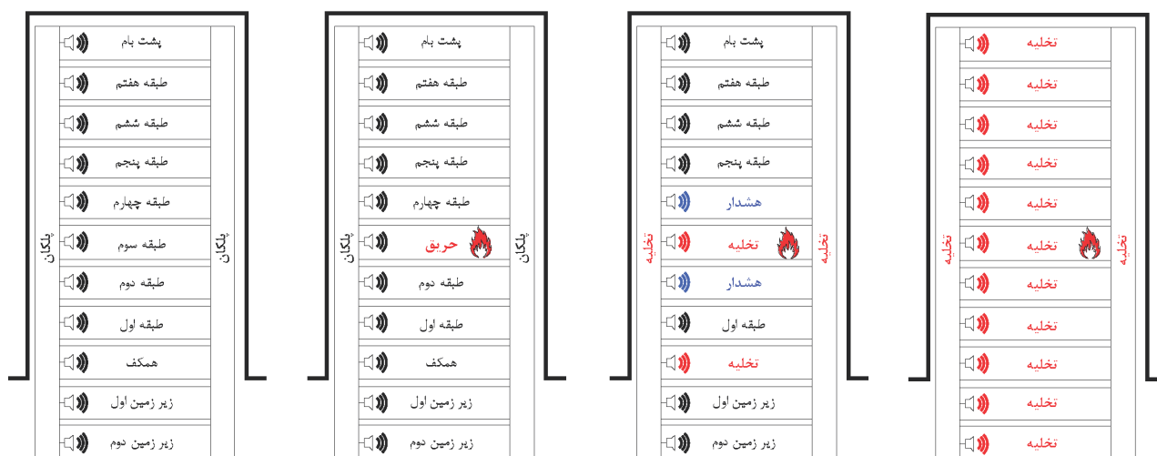
شکل ۴-۲۴- سناریوی تخلیه در یک ساختمان
