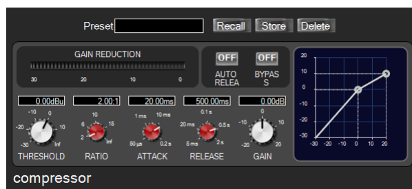
شکل ۷-۵۲ - نمونه کنترل نرم‌افزاری کمپرسور دیجیتال
