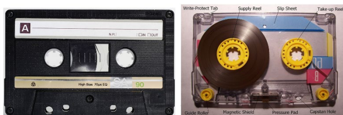
شکل ۷-۹۶- یک نمونه نوار کاست و ساختار داخلی آن
