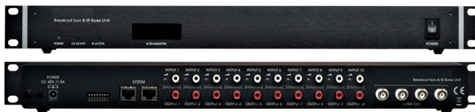
شکل ۸-۹- یک نمونه دستگاه مرکزی ترجمه هم‌زمان ۱۰ زبانه
