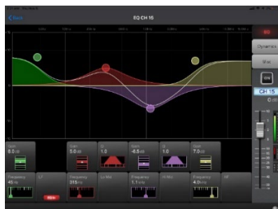
شکل ۷-۴۷- یک نمونه نرم‌افزار کنترل اکولایزر پارامتریک دیجیتال
