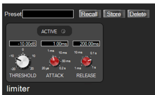
شکل ۷-۵۰ - نمونه کنترل نرم‌افزاری محدودکننده دیجیتال
