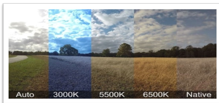
شکل ۳-۲۲- تنظیم خودکار سطح سفیدی در دوربین‌های رنگی
