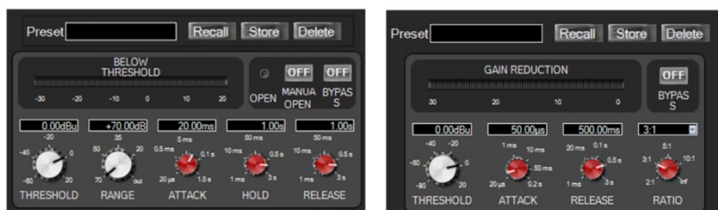
شکل ۷-۵۶- الف- نمونه نرم‌افزار کنترل اکسپندر گیت دیجیتال
