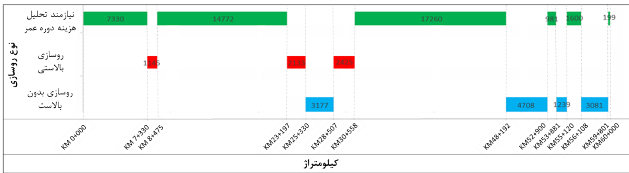
شکل الف-۴- انتخاب سیستم روسازی بر مبنای معیارهای الزام آور
