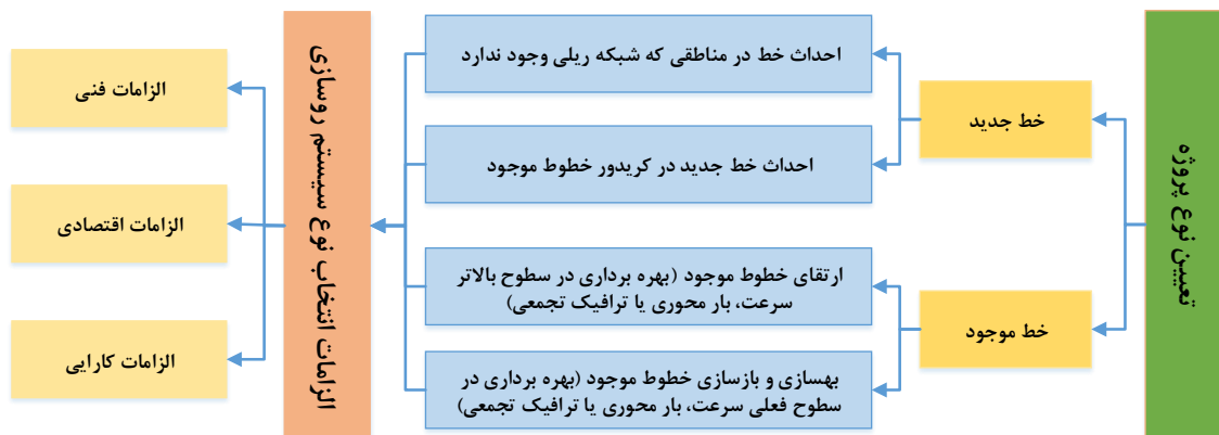
شکل ۳-۱ انواع پروژه‌های احداث و توسعه خطوط ریلی و دسته‌بندی کلی الزامات انتخاب روسازی
