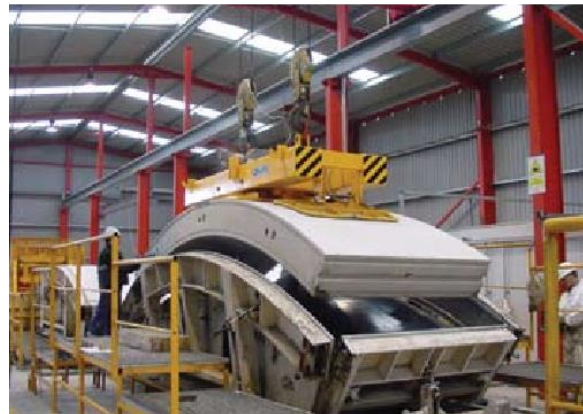
الف) خروج سگمنت از قالب بوسیله مکش
