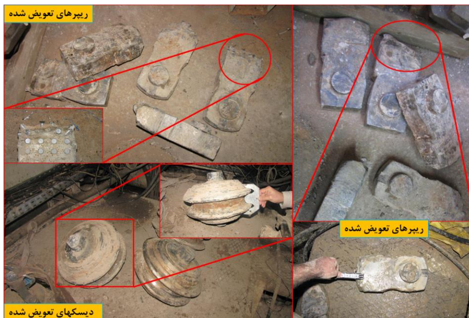
شکل ۲-۱۸: ابزارهای برش تعویض شده در یک دوره
