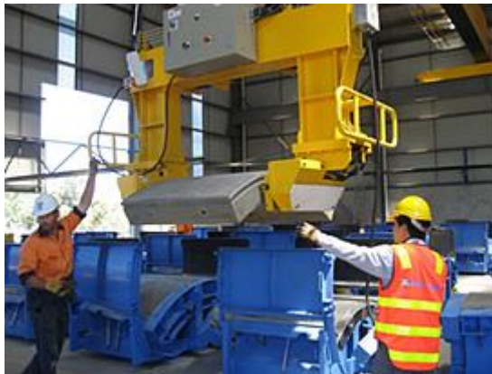
ب) خروج سگمنت از قالب بوسیله جک مکانیکی
