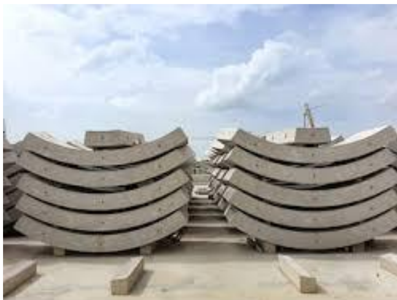
شکل ۲-۳: دپوی دائم سگمنت‌ها
