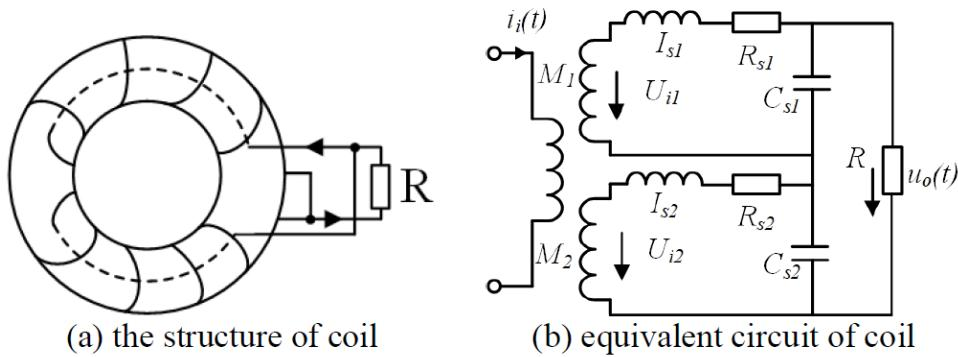
شکل ۲۱-۷: ساختار و مدار معادل سیمپیچ روگوفسکی با SNR بهبود یافته
