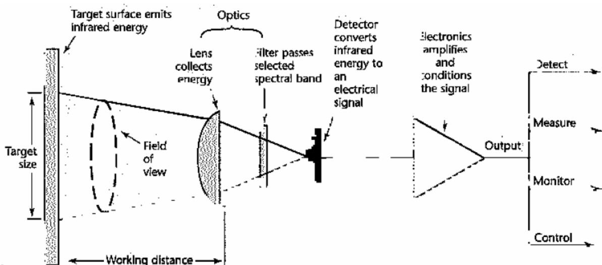
شکل ۲-۳: ساختار تشکیل دهنده دوربین گرمگاری
