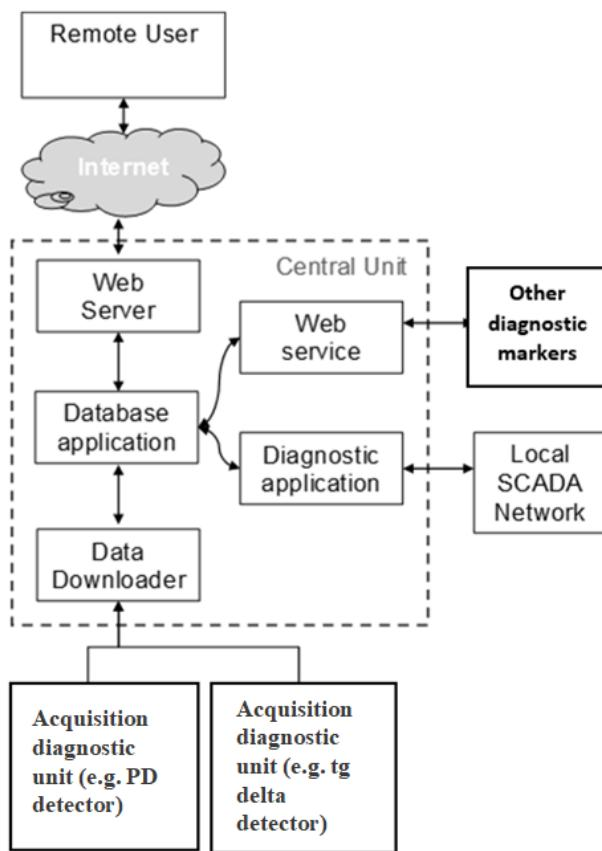
شکل ۷-۸: طرح سیستم نظارت بر شرایط و واسطه با مدیریت شبکه
