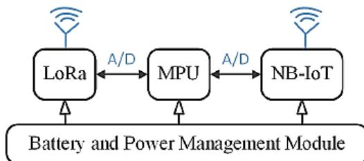
شکل ۱۳-۷: دیاگرام بلوکی ساختار دروازه LoRa-NB-IoT
