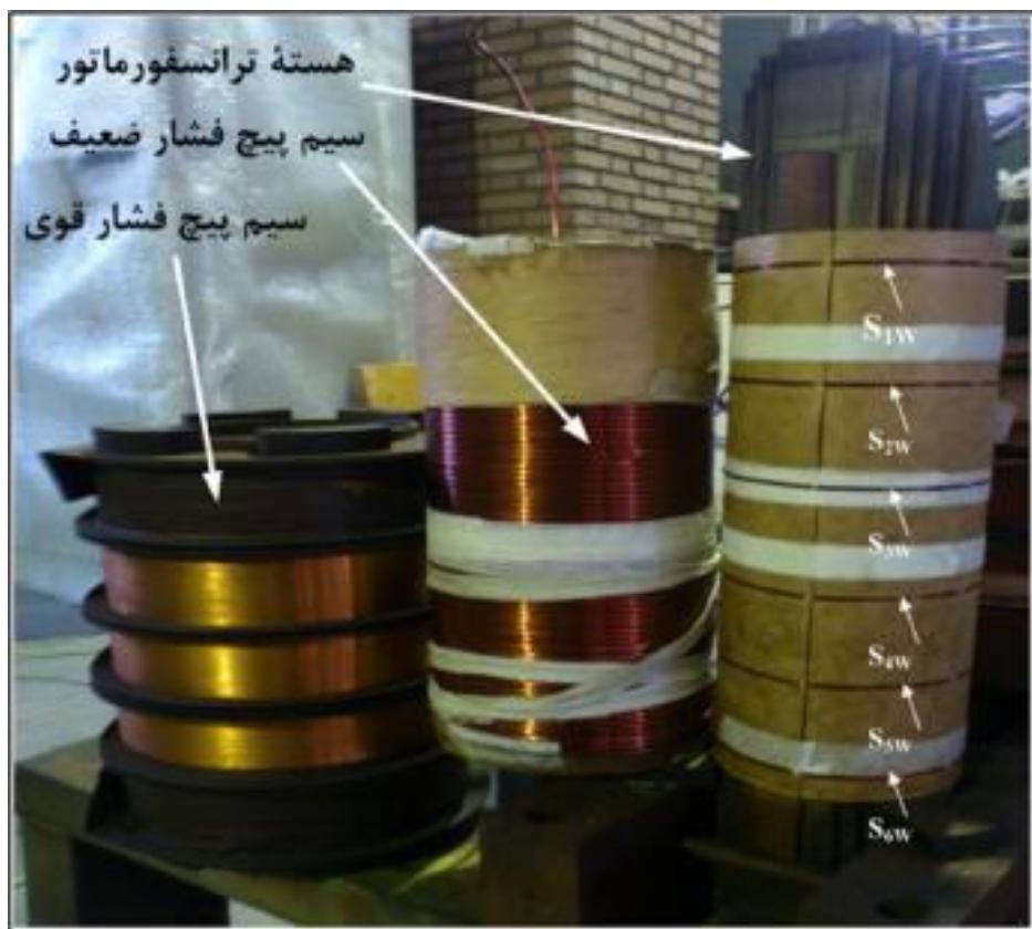
شکل ۲۷-۲: حسگرهای نصب شده بر روی هسته ترانسفورماتور نمونه در فاز W
