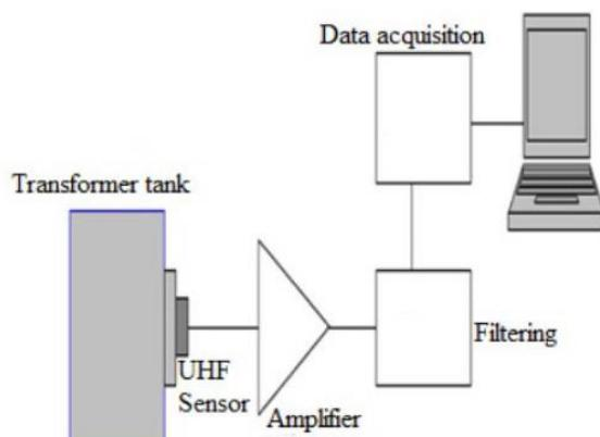
شکل ۴۳-۲: اجزای سیستم تشخیص تخلیه جزئی با استفاده از UHF
