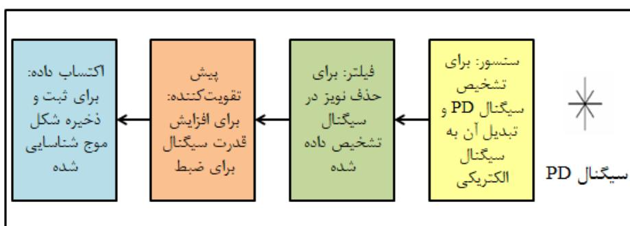
شکل ۲: بلوك دیاگرام کلی یک سیستم آشکارساز صوتی
