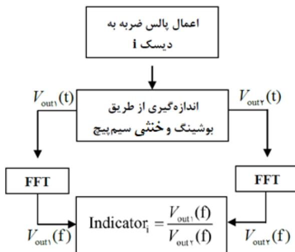
شکل ۳-۲: تشکیل جدول جستجو شاخص سیم‌پیچ برای  $n, 2, 1, \dots, i=1$  (شماره دیسک)
