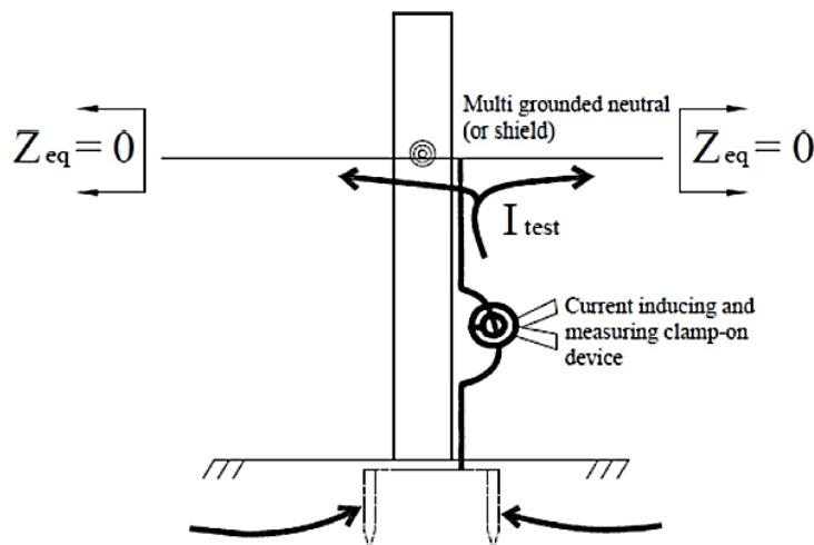
شکل ۷-۶: اندازه‌گیری مقاومت به وسیله روش (کلمپ)
