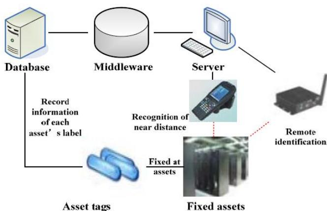
شکل ۳۸-۷: استفاده از فناوری اینترنت اشیاء در مدیریت دارایی [۱۶۶]
