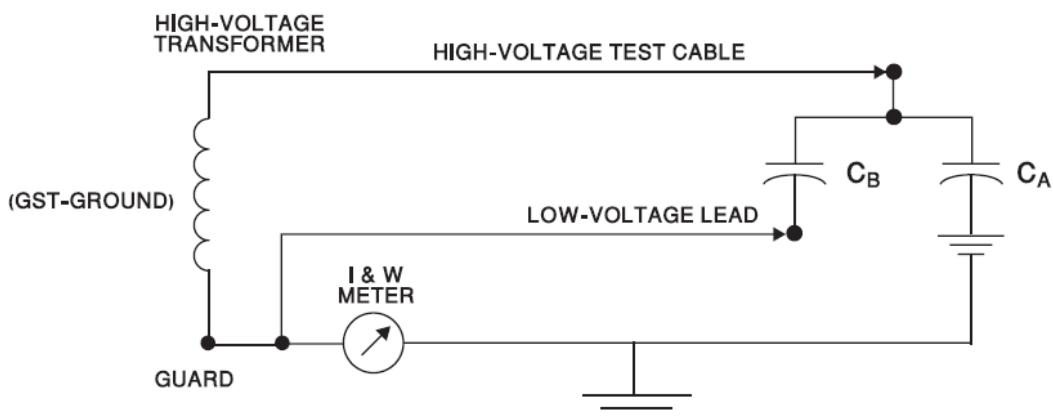
شکل ۱۴-۵: آزمایش بوشینگ کندانسوری دارای تپ در حالت اتصال به گارد در این حالت تنها خازن  $C_A$  آزمایش می‌شود.
