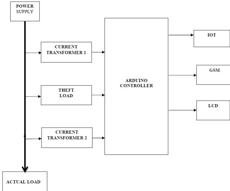
شکل ۳۶-۷: دیاگرام بلوکی مدار تشخیص سرقت انرژی الکتریکی در شبکه هوشمند مبتنی بر اینترنت اشیاء [۱۶۲]
