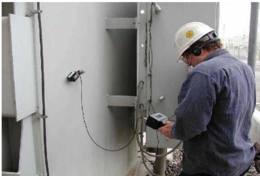
شکل ۲۱-۲: آشکارسازی تحلیه جزئی در ترانسفورماتور قدرت با استفاده از سنسور AE
