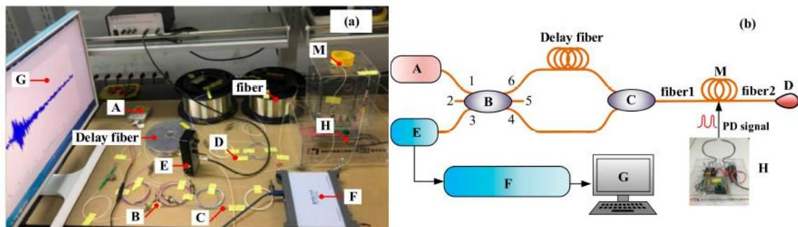
شکل ۲۷-۴: OFPDS. (a) دیاگرام تجهیزات آزمایشی و (b) شماتیک دیاگرام آزمایشی
