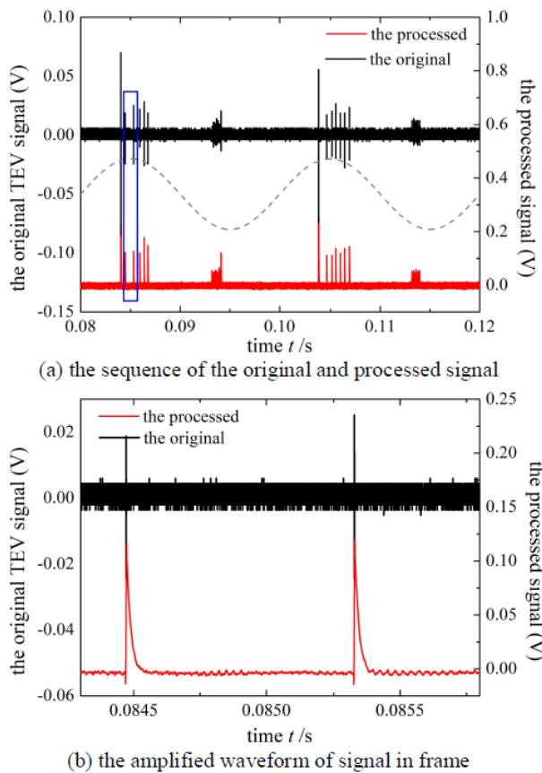
شکل ۱۶-۷: توالی و شکل موج تقویت شده سیگنال اصلی و سیگنال پردازش شده
