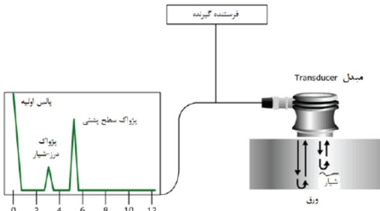
شکل ۹-۴: شماتیک اجزاء و نحوه کارکرد یک سیستم متداول فراصوت
