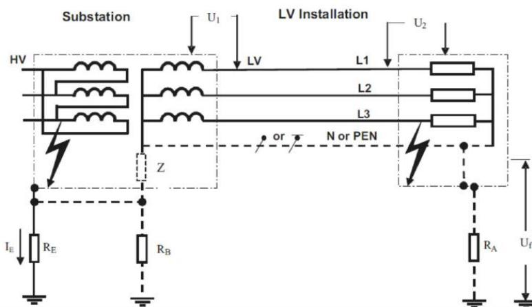
شکل ۱۵-۶: ساختار استاندارد یک طرح پست ترانسفورماتور زمینی [۹۱]
