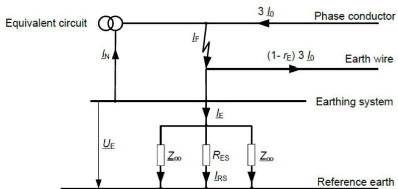
شکل ۱۴-۶: مدار معادل شکل ۱۳-۶ [۹۱]
