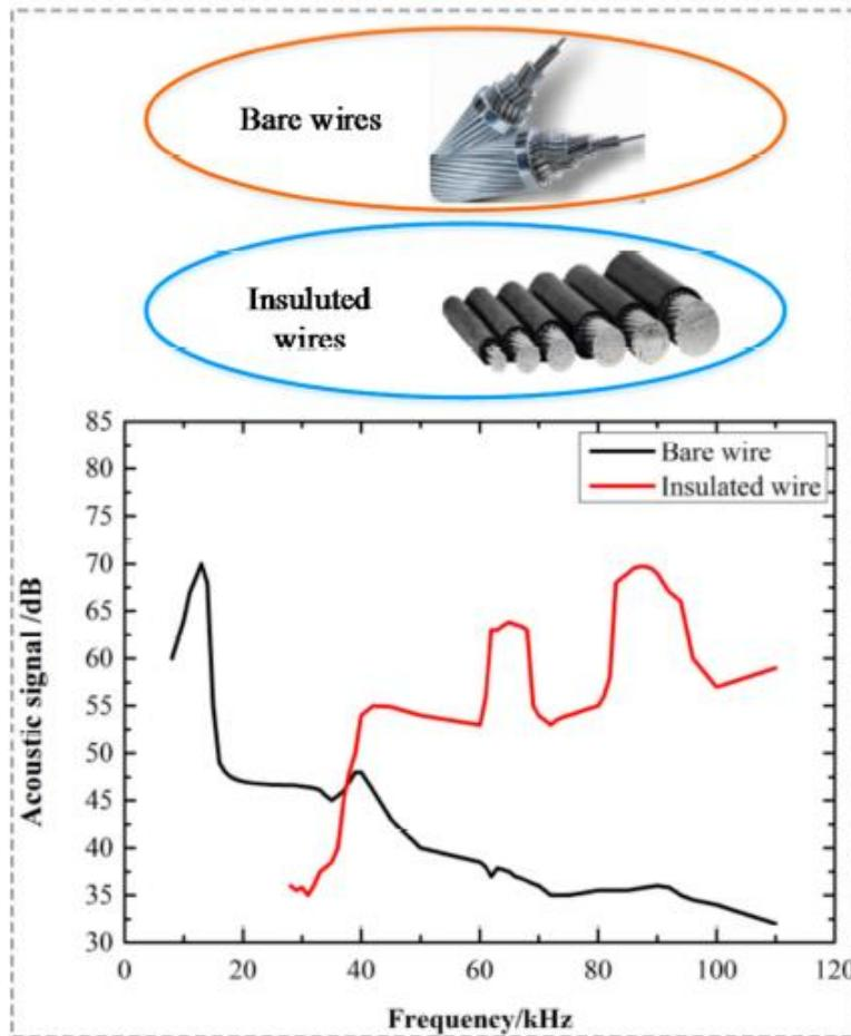
شکل ۲۶-۴: سیم بدون عایق و سیم عایق دار و طیف تخلیه آنها در هوا
