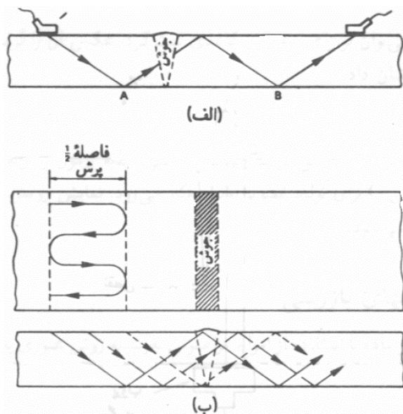
شکل ۱۹-۴: روش عبوری با پروب زاویه‌ای (الف) موقعیت پروب‌ها، (ب) روش روش برای بازرسی کامل جوش
