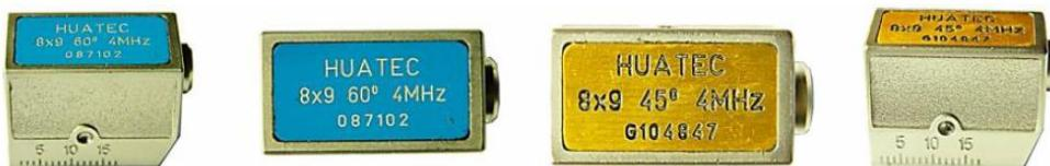
شکل ۱۴-۴: چند نمونه پروب زاویه‌ای
