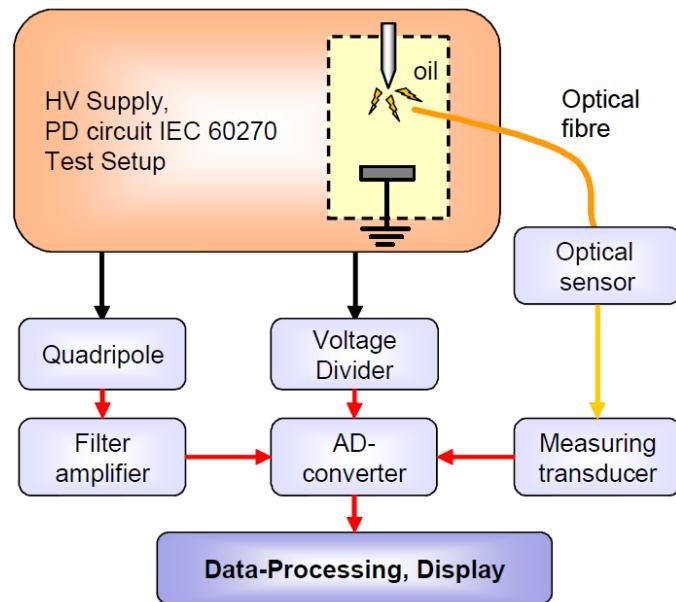
شکل ۱۶-۲: شماتیک نحوه اندازه‌گیری نوری تخلیه جزئی
