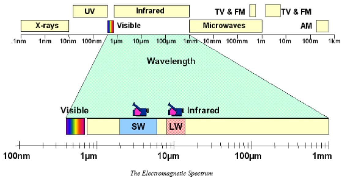
شکل ۳: نمایی از طیف امواج الکترومغناطیس
