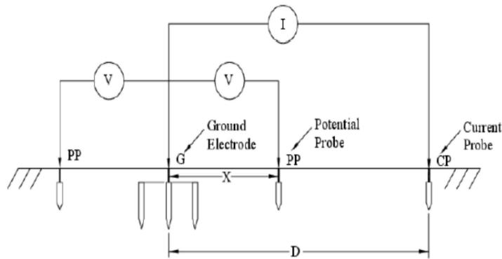
شکل ۲-۶: شماتیک روش افت پتانسیل
