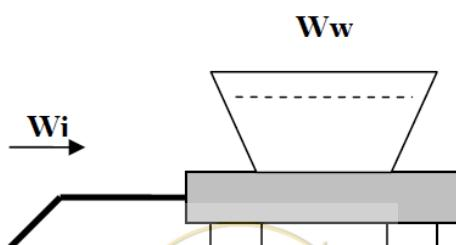
شکل ۸-۳: هیتر الکتریکی در نظر گرفته شده برای بیان انرژی تلف شده در اتصالات سست
