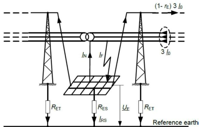
شکل ۱۳-۶: شماتیک جریان اتصال کوتاه زمین در حالت کلی در شبکه‌های بالای ۱KV
