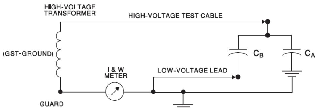
شکل ۱۳-۵: آزمایش بوشینگ کندانسوری دارای تپ در حالت GST
