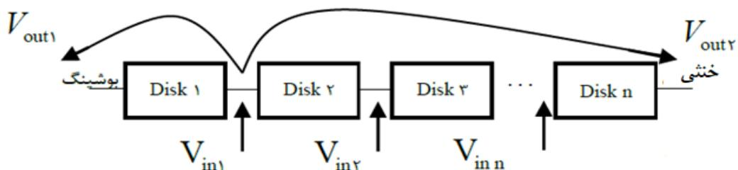
شکل ۲-۲: شماتیک یک سیمپیج دیسکی
