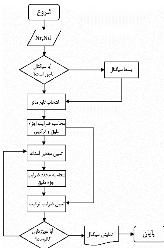
شکل ۳۱-۲: فلوچارت نویزدایی (شناسایی تخلیه جزئی) به وسیله تبدیل موجک
