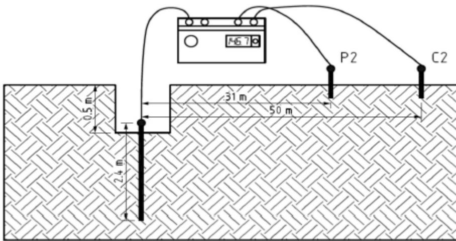
شکل ۲۰-۶: اندازه‌گیری مقاومت خاک با روش تک میله
