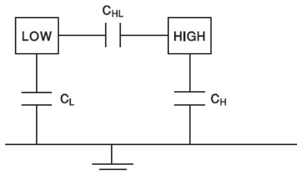
شکل ۱۵-۵: ترانسفورماتور دو سیم‌پیچه
