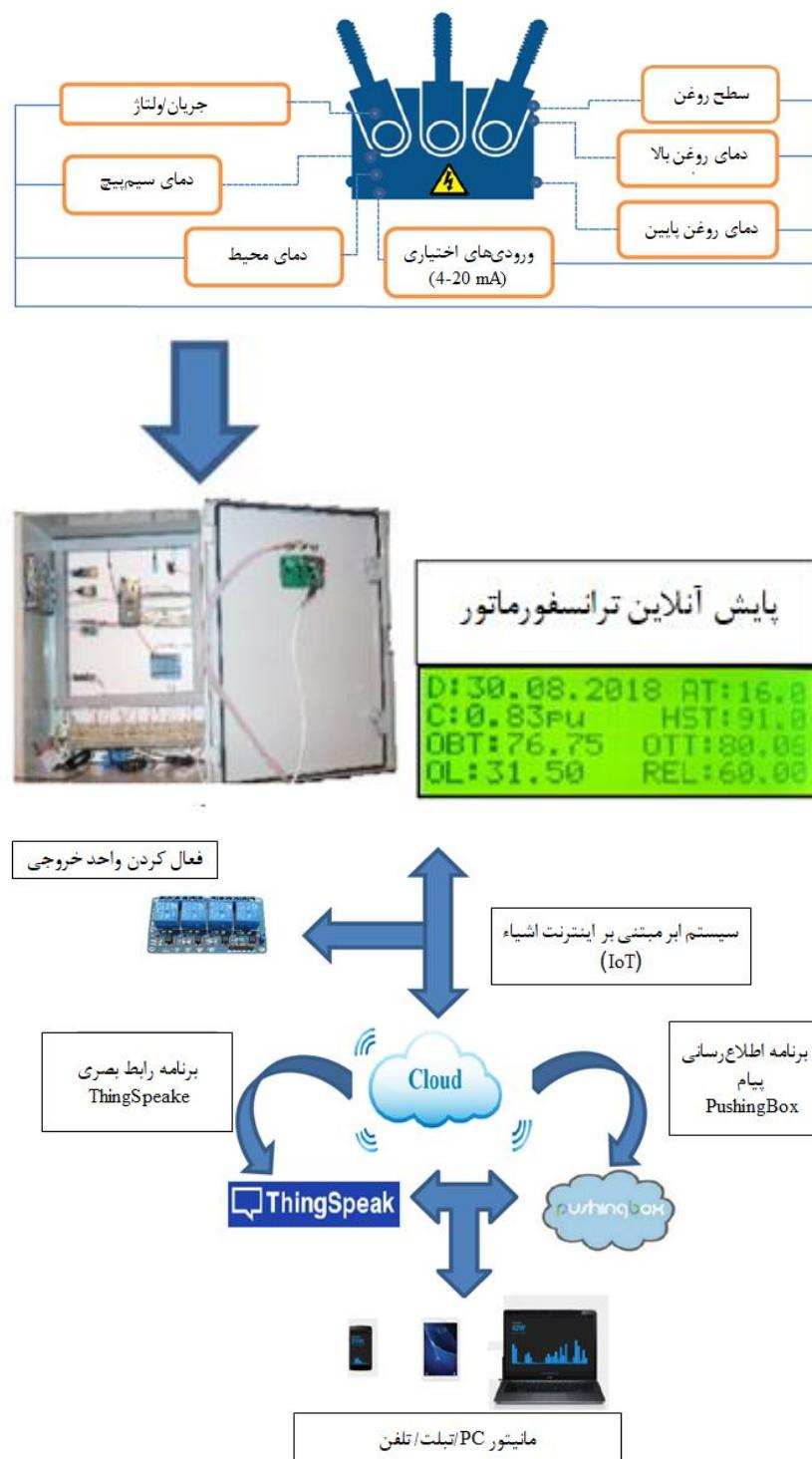
شکل ۷-۲۶: بلک دیاگرام سیستم پایش ترانسفورماتور
