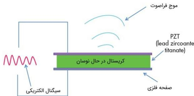
شکل ۱۲-۴: شماتیک یک کریستال پیزوالکتریک برای تولید امواج فراصوت
