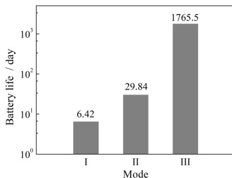
شکل ۲۴-۷: عمر باتری (۳/۷ ولت و ۱۰۰۰۰ میلی آمپر ساعت) در سه حالت عملکردی
