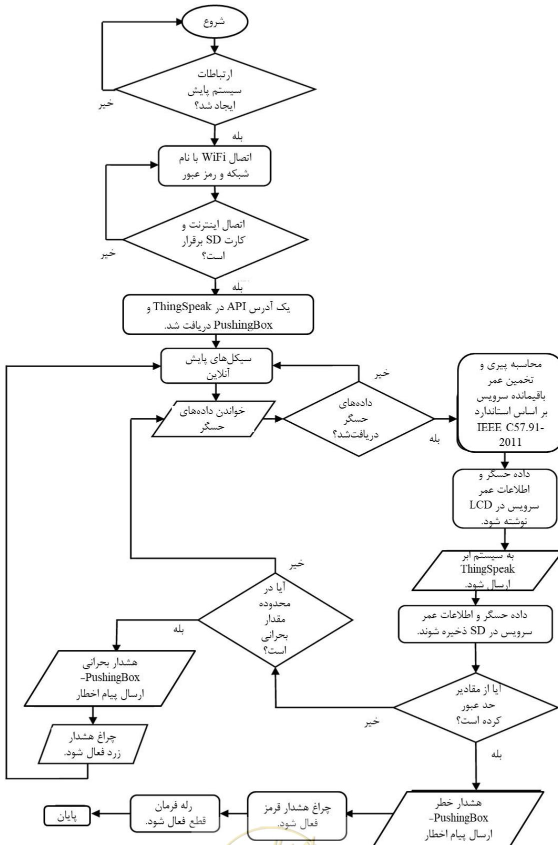
شکل ۲۷-۷: فلوچارت نحوه کار سیستم پایش ترانسفورماتور
