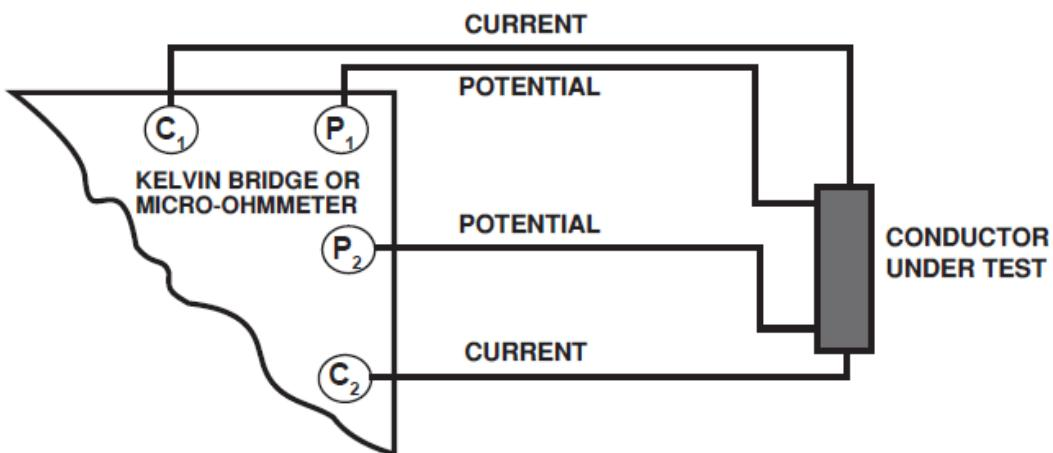
شکل ۲-۵: مدار اتصالات در اندازه‌گیری مقاومت اهمی به روش میکرواهم‌متر یا پل کلوین
