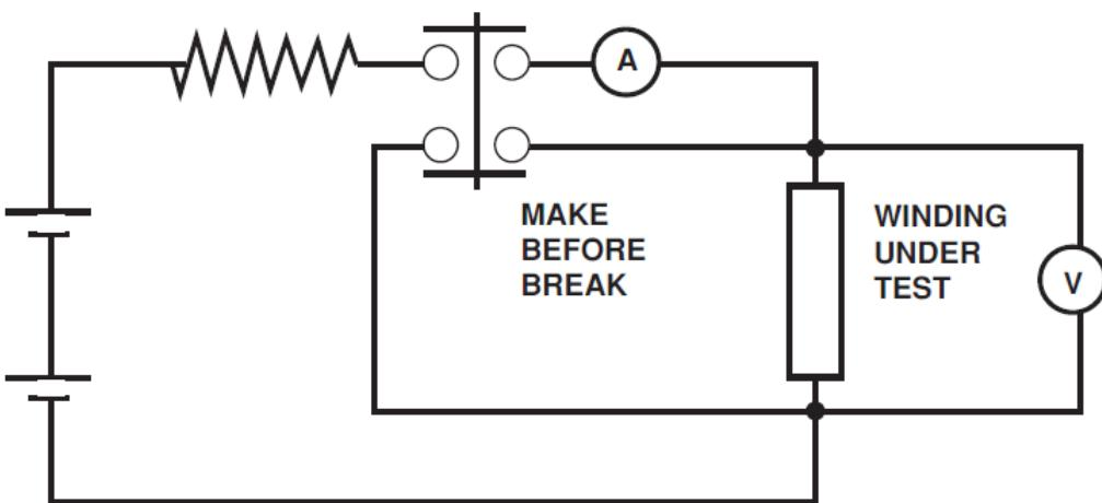
شکل ۵-۵: مدار اندازه‌گیری مقاومت سیم پیچ با استفاده از روش ولت‌متر-آمپر متر
