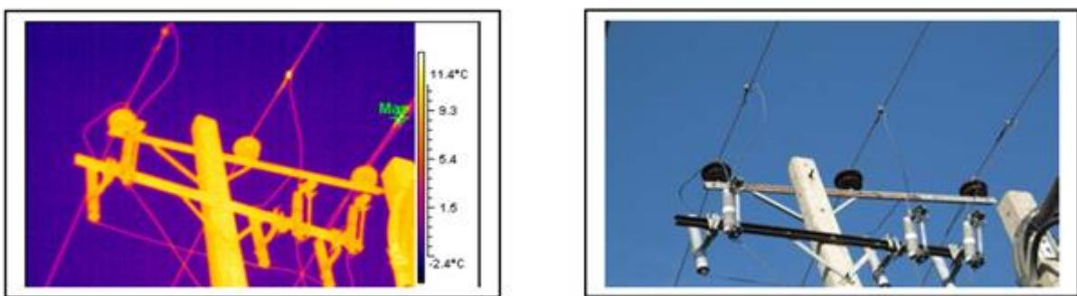
شکل ۳-۳: تصویر معمولی و حرارتی برقگیر و کاتاوت‌ها
