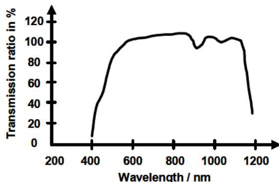
شکل ۱۵-۲: مشخصات انتقال روغن ترانسفورماتور
