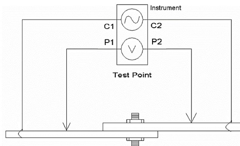
شکل ۱-۶: اندازه‌گیری مقاومت دو سر اتصالات با میکرو اهمتر چهار ترمیناله
