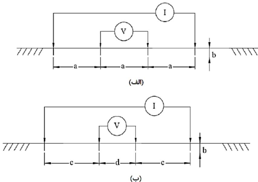
شکل ۱۹-۶: روش چهار نقطه، (الف) آرایش ونر و (ب) آرایش شلومبرگر-پالمر
