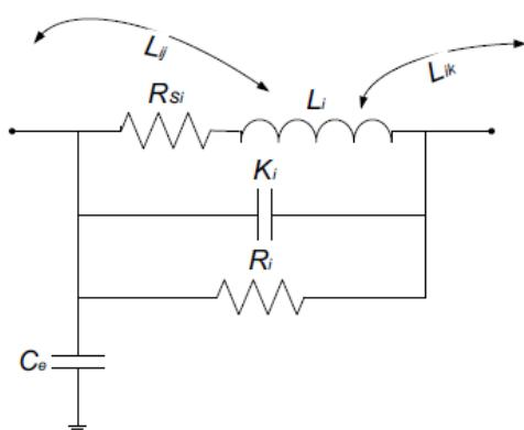
شکل ۸-۲: نمایش مدل مشروح یک ترانسفورماتور
