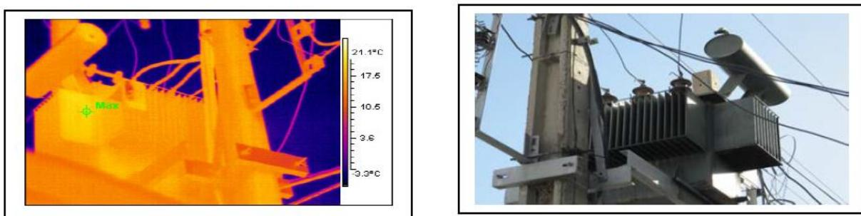
شکل ۴-۳: تصویر معمولی و تصویر حرارتی ترانسفورماتور توزیع
