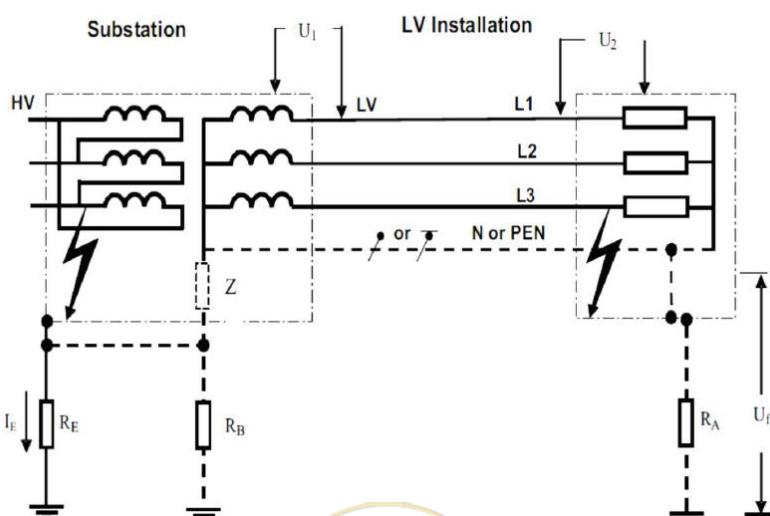
شکل ۸-۶: آرایش مختلف سیستم‌های زمین در پست ترانسفورماتوری و تاسیسات ولتاژ پایین
