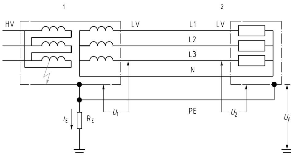
شکل ۹-۶: شماتیک پست ترانسفورماتور با یک الکترود زمین مشترک حفاظتی/خنثی در سیستم TN
