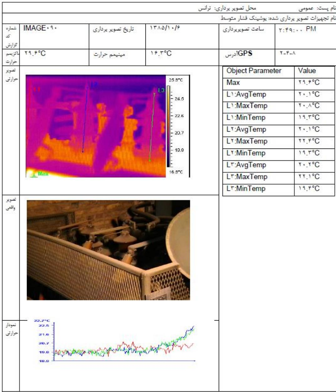
شکل ۱۴-۳: نمونه گزارش تصویربرداری حرارتی مطابق با دستورالعمل اجرایی توانیر
