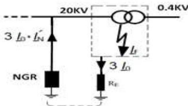
شکل ۱۶-۶: ساختار استاندارد محدود کردن جریان اتصال کوتاه در شبکه توزیع ولتاژ متوسط
