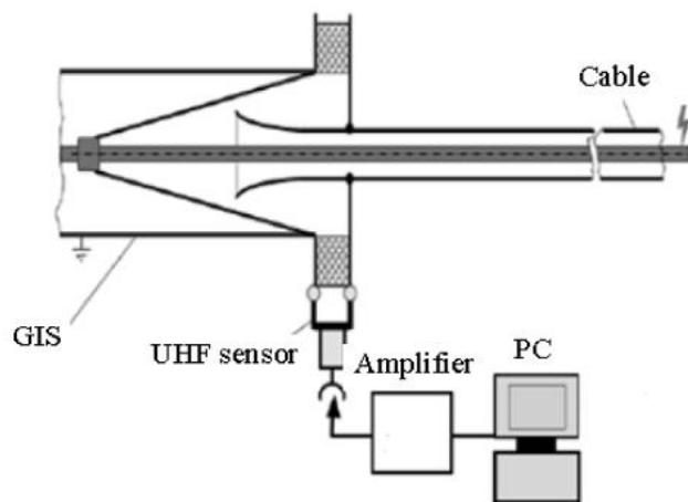
شکل ۴۲-۲: سنسور UHF تخلیه جزئی متصل شده به انتهای ولتاژ بالا و خیلی بالا [۲۱]
