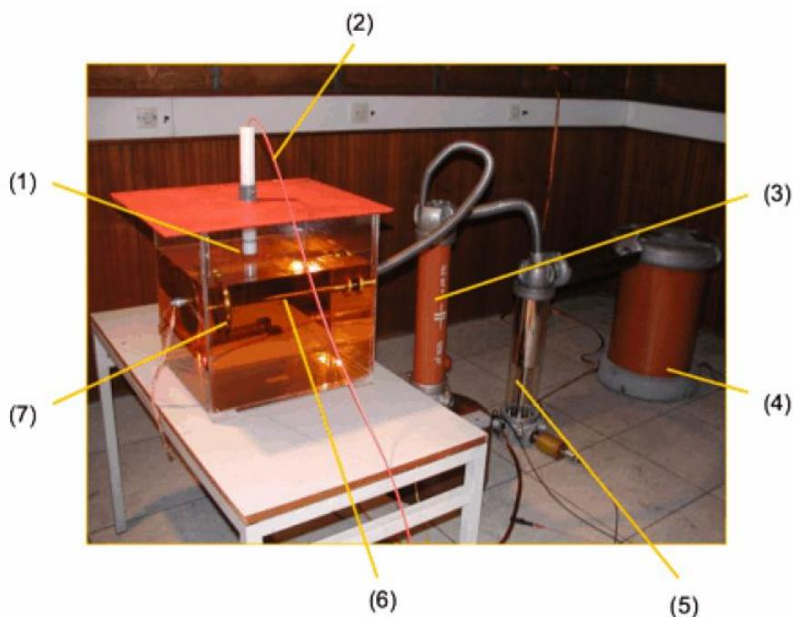
شکل ۱۷-۲: تنظیمات تست آزمایشگاهی (۱) سنسور نوری، (۲) فiber نوری، (۳) خازن کوبلاژ، (۴) منبع ولتاژ بالا، (۵) تقسیم کننده ولتاژ، (۶) Peak-plate و (۷) روغن ترانسفورماتور
