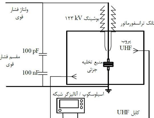
شکل ۴۰-۲: شماتیک مدار اندازه‌گیری پارامترهای پروب و تخلیه جزئی
