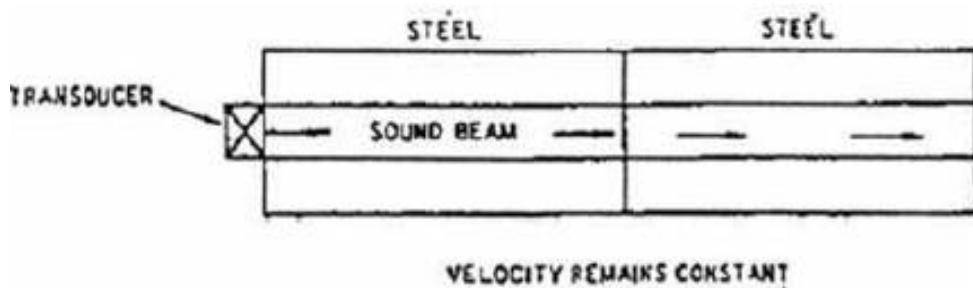
شکل ۲-۴: انتقال موج در دو محیط فولادی
