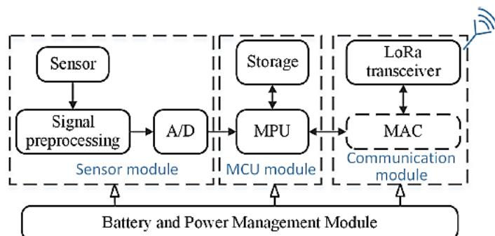
شکل ۱۱-۷: ساختار بلوکی گره حسگر بی‌سیم
