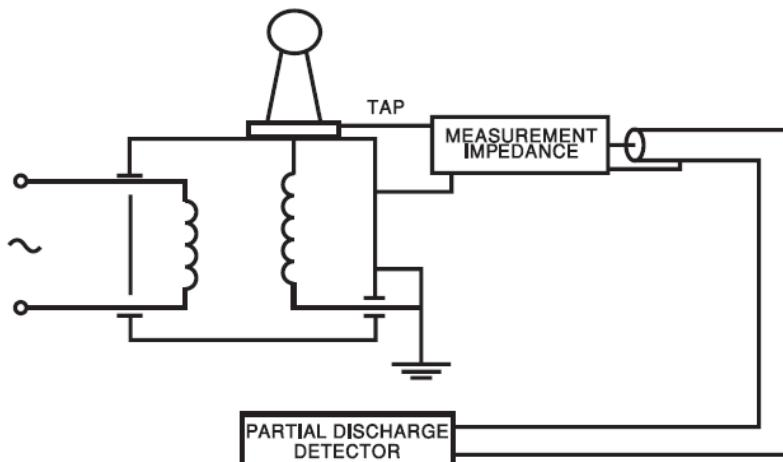
شکل ۸-۵: مدار اندازه‌گیری تخلیه جزئی با استفاده از تپ بوشینگ
