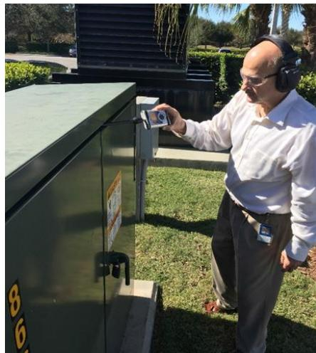
شکل ۲۴-۴: بکارگیری سیستم فراصوت با قابلیت نصب بر روی ترانسفورماتور
