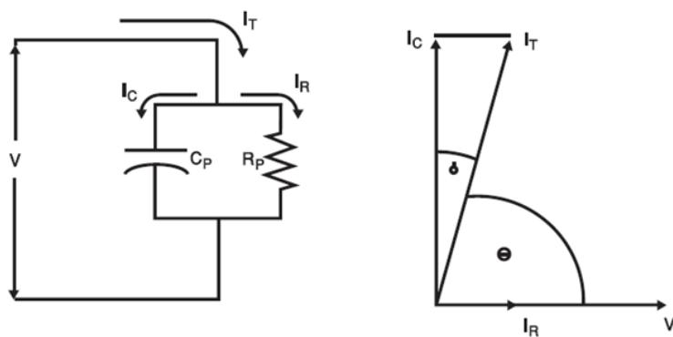
ج. ۶-۵: دیاگرام برداری در آزمایش ضریب پراکندگی توان (ضریب تلف شده)
