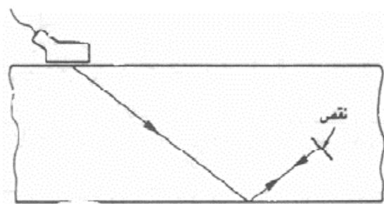
شکل ۲۰-۴: روش بازتابی با پروب زاویه‌ای
