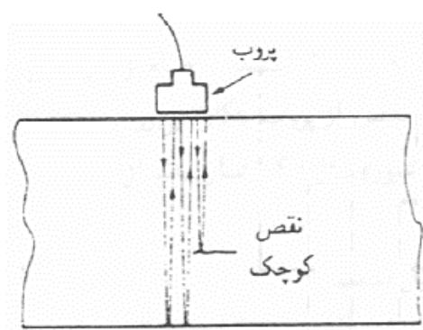
شکل ۱۷-۴: روش بازتاب با پروب عمودی
