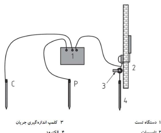
شکل ۶-۶: روش تست ۳ ترمیناله با گیره CT
