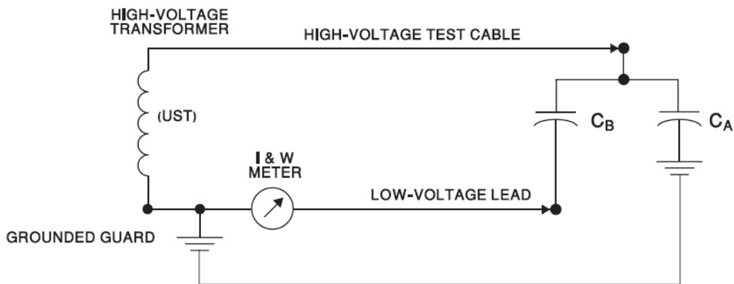
شکل ۱۲-۵: آزمایش یک بوشینگ کندانسوری دارای تپ در حالت UST (روش آزمایش تجهیز بدون اتصال به زمین) که تنها  $C_B$  آزمایش می‌شود
