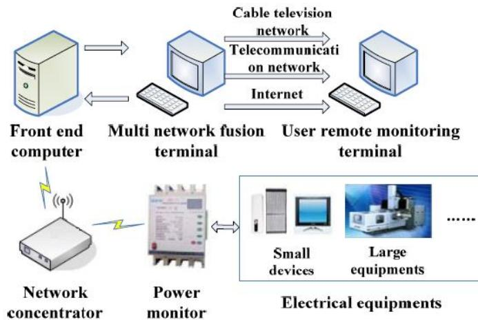
شکل ۳۵-۷: فرایند نظارت بر توان مصرفی در شبکه هوشمند با استفاده از اینترنت اشیاء [۱۶۱]
