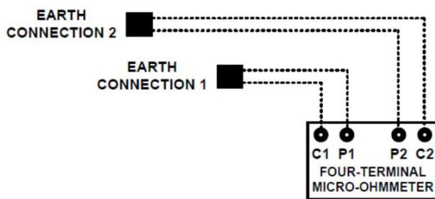
شکل ۱۷-۶: اندازه‌گیری مقاومت بین دو سیستم زمین (حلقه) با میکرواهم‌متر
