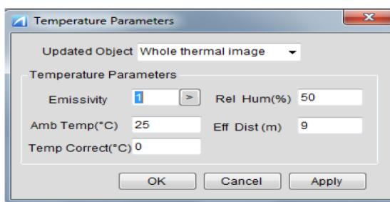
شکل ۱۱-۳: پنجره پارامترهای دمایی در نرم‌افزار مخصوص تصویربرداری حرارتی
