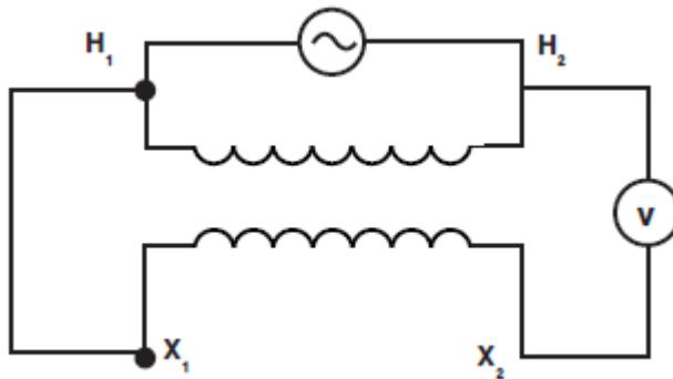
شکل ۴-۵: آزمایش پلاریته با استفاده از روش AC
