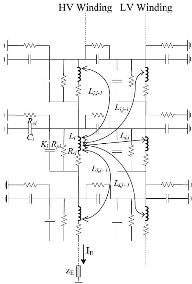
شکل ۹-۲: نمایش مدل مشروح یک ترانسفورماتور
