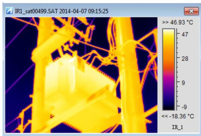
شکل ۱۰-۳: یک نمونه تصویر حرارتی از بدنه یک ترانسفورماتور
