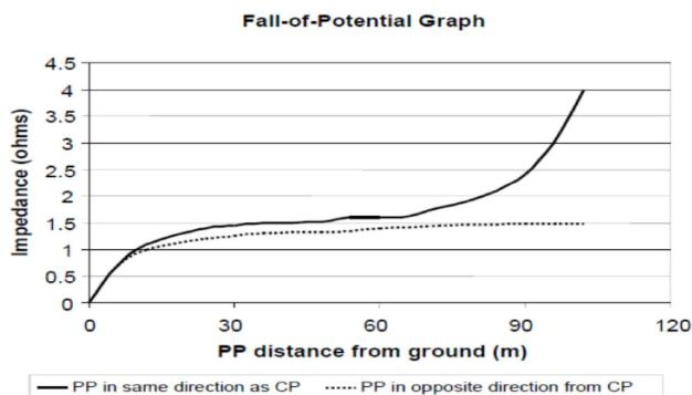
شکل ۳-۶: منحنی نوعی امپدانس بر حسب فاصله پروب پتانسیل در روش افت پتانسیل
