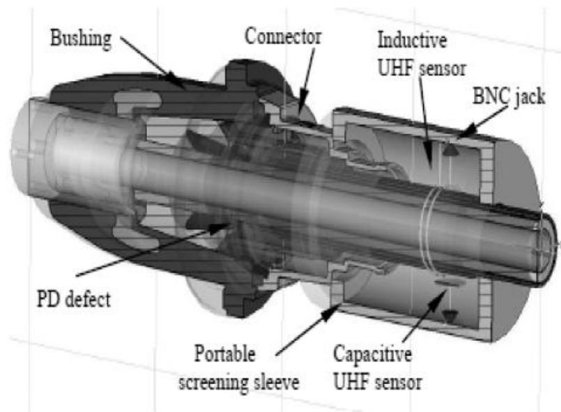
شکل ۴۱-۲: انتهای کابل پلاگین و اصول تشخیص تخلیه جزئی با UHF
