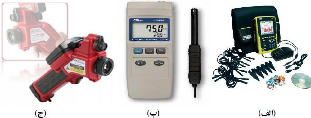
شکل ۹-۳: الف- پاور آنالایزر، ب- رطوبت‌سنج و دماسنجد، ج- دوربین گرمانگاری
