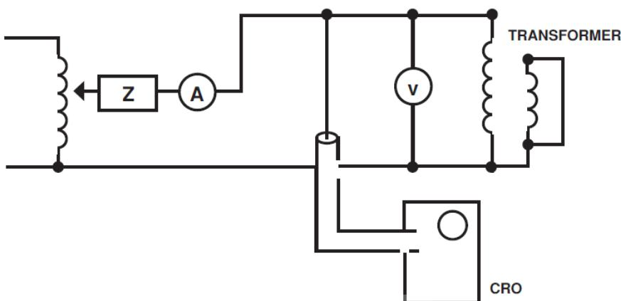
شکل ۵-۵: مدار اندازه‌گیری امپدانس اتصال کوتاه در ترانسفورماتورهای تکفاز
