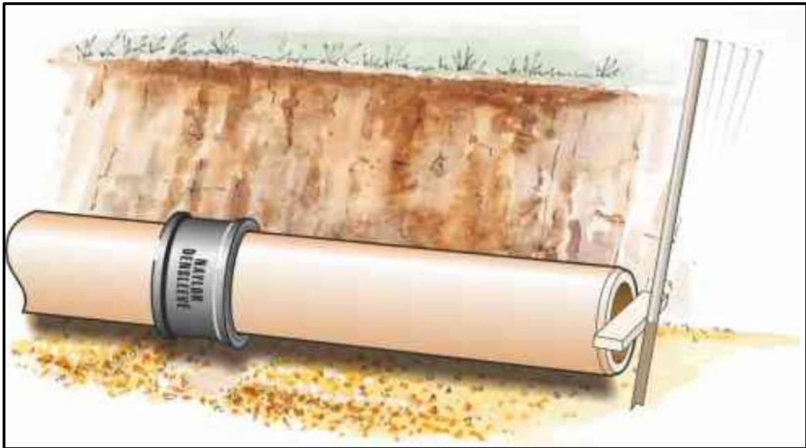
شکل ۲-۳۱- استفاده از قطعه چوب/الوار برای هل دادن لوله به درون مادگی/کوپلینگ
