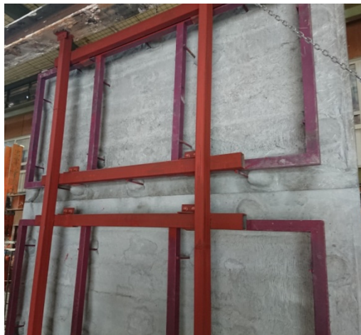
شکل ۱۱-۱۳- نمونه‌هایی از لایه پیوندی و مهارهای انعطاف‌پذیر
