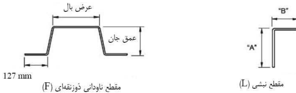
شکل ۱-۲ انواع اعضای موجود در قاببندی‌های فولادی سرد نوردشده
