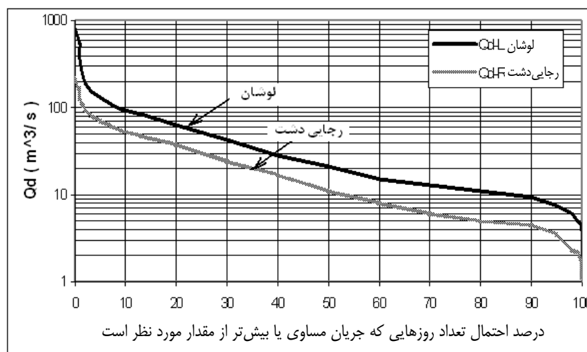
شکل ۴-۱۱- منحنی‌های دوام جریان ایستگاه مبنا و ایستگاه فاقد آمار رسوب برای تعیین متوسط رسوب سالیانه (رودخانه شاهرود، ایستگاه لوشان (مبنا) و ایستگاه رجایی دشت (دوره آماری ۲۰ ساله، ۶۷-۱۳۴۷))
