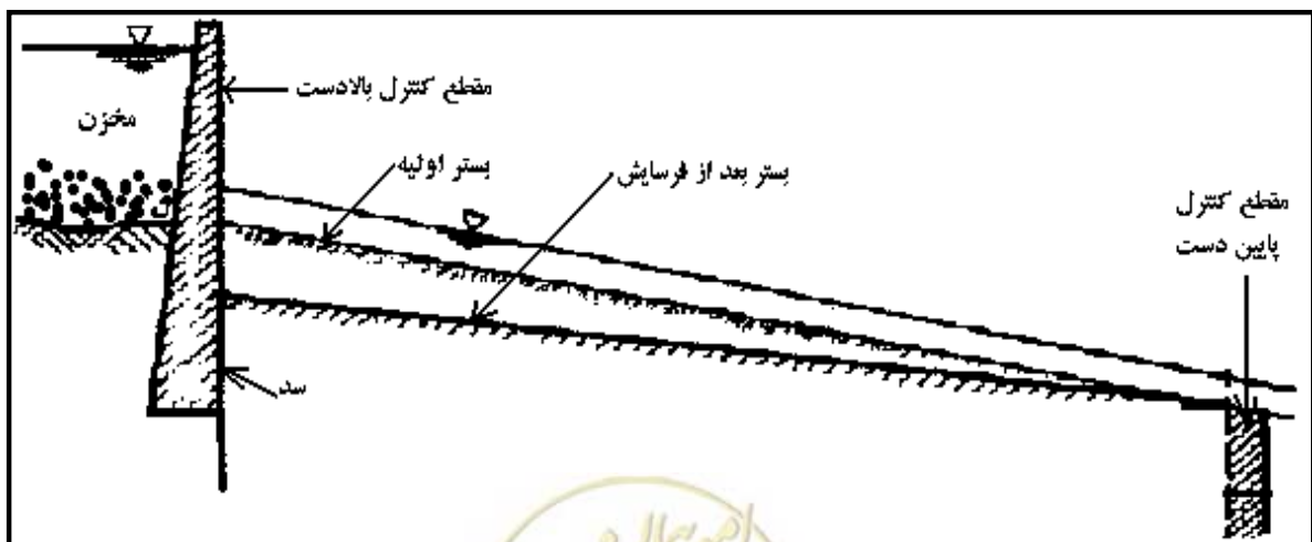
شکل ۷-۳- فرسایش عمومی در پایین دست سد مخزنی ناشی از تله اندازی رسوب در بالادست و افزایش ظرفیت انتقال در پایین دست [۲۰]
