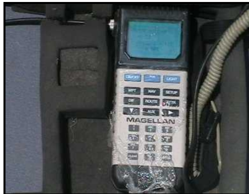
شکل ۳-۶- GPS تک فرکانسه MAGELLAN با دقت
