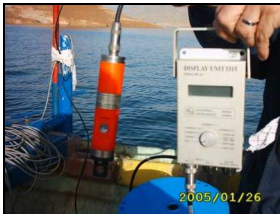
شکل ۳-۷- قسمت‌های مختلف دستگاه سرعت سنج صوتی (CTD)
