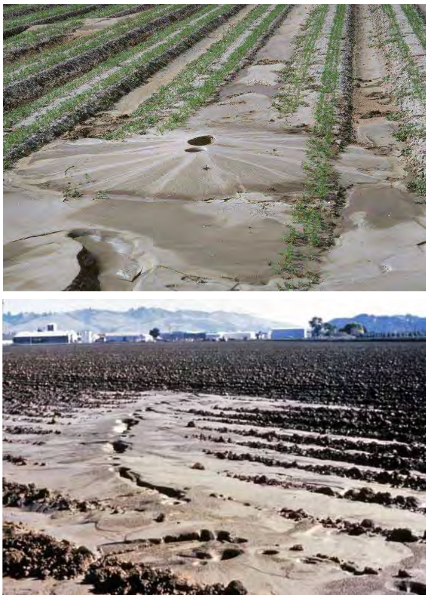
شکل ۱-۲- نمونه‌هایی از وقوع جوشش ماسه
