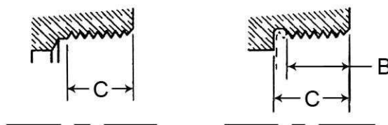
جدول شماره (۲-۷-۲-۳) "ب" (۸)، از استاندارد MSS SP-80:1997 حداقل طول و عمق دنده‌ها در شیرهای کشویی برنزی با اتصال دنده‌ای
